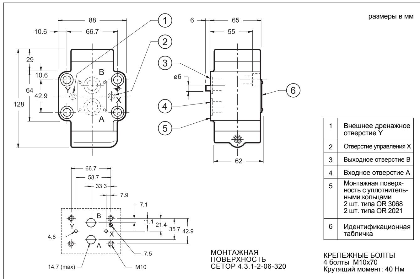
5 - ГАБАРИТНЫЕ И МОНТАЖНЫЕ РАЗМЕРЫ VP 5 P\*-MU
