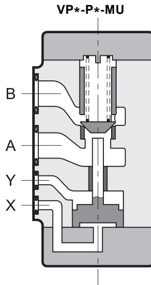
**VP\*-P\*P-MU** Клапаны VP\*-P\*P-MU представляют собой обратные клапаны с гидравлическим управлением, которые, в дополнение к характеристикам предыдущей версии, оборудованы декомпрессионным клапаном. Они рекомендуются к использованию при высоких рабочих давлениях или при высоких нагрузках, выступающих в качестве умножителей давления.
