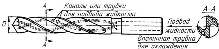
Рисунок 3.15 – Спиральное сверло для глубокого сверления
