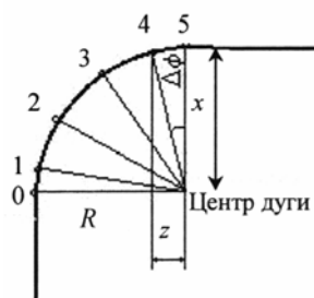
Рис. 27 Аппроксимация дуги окружности
