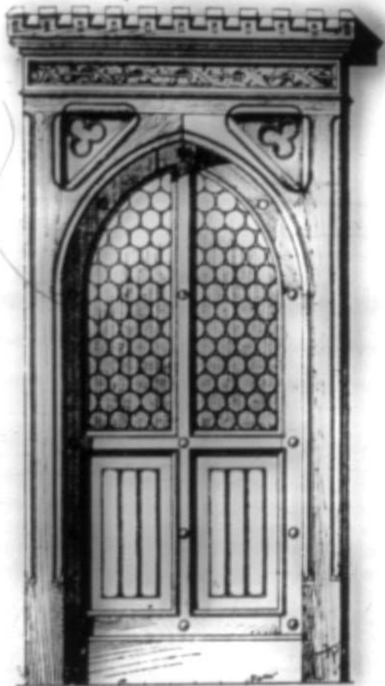
Fig. 221. Door in stone or brick.
