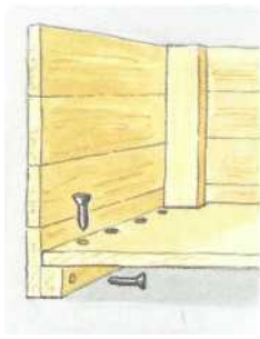
2 Для установки дна приделайте планку по двум продольным сторонам емкости.
