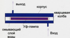
Рис. 26. Ультрафиолетовый стерилизатор с промежуточной колбой из кварцевого стекла.
