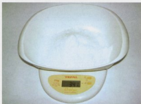
Для взвешивания морской соли хорошо подходят электронные бытовые весы с точностью до 2 граммов. Фото А. Иванова.
