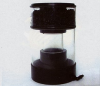
При использовании озона в пеноотделительной колонке на пеноотборной камере монтируется дополнительная секция с активированным углем, как в колонке "Berlin" (Израиль). Фото А. Иванова.
