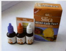
Тест для измерения содержания кремния в морской воде. Фото А. Иванова.
