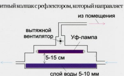
Рис. 27. УФ-лампа располагается над мелкой емкостью с проточной водой.
