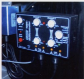
Мультиконтроллер "Timpze 7094" предназначен для формирования естественного движения воды в рифовом аквариуме. Фото А. Иванова.
