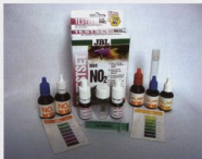
Тесты для определения нитритов и аммония в созревающем биофильтре. Фото А. Иванова.
