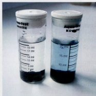
В левой пробирке тест на фосфаты проходил активированный уголь Ehfiaktiv (Eheim), справа — продукт польского происхождения. Фото А. Иванова.
