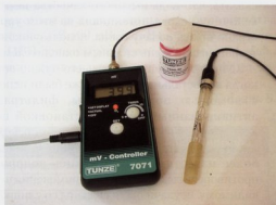
Прибор для определения значения редокс-потенциала в аквариуме и управления включением/выключением подачи озона. Фото А. Иванова.
