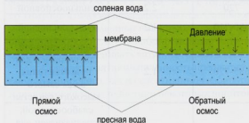
Рис. 12. Поведение растворов с разной плотностью при прямом и обратном осмосе.
