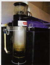
Подвесная колонка "Berlin Classic", использующая принцип Вентури. Фото А. Иванова.
