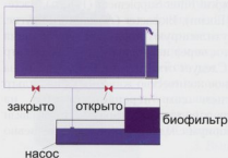
Рис. 15. Схема зарядки биофильтра. После созревания вентиль подачи воды на аквариум открывают, а на фильтр закрывают.
