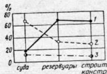
Рис. 18. Зависимость относительного числа разрушений от конструктивных технологических и эксплуатационных факторов
