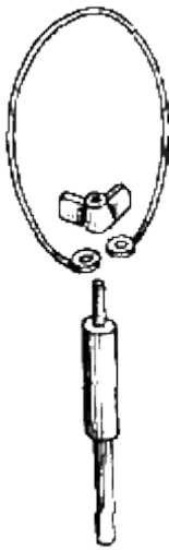
Рис. 45. Соединение кольца с рукояткой сачка
