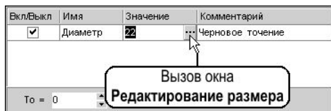
Рис. 9.16. Вызов окна Редактирование размера из таблицы параметров
