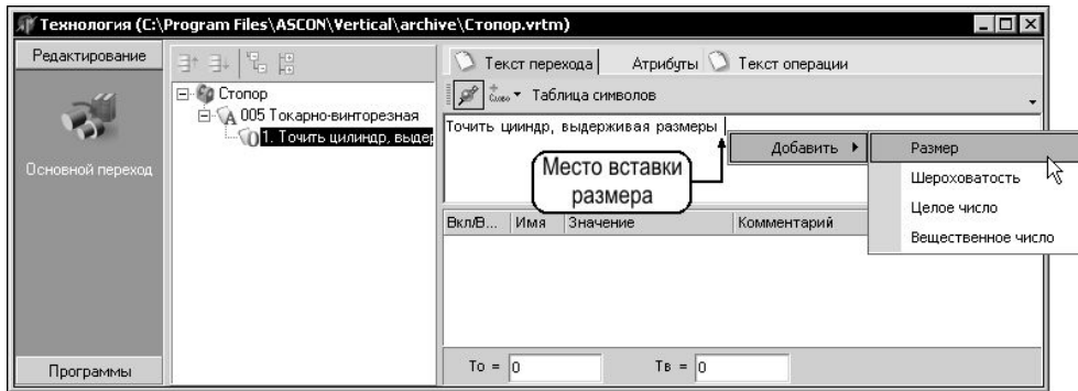
Рис. 9.11. Редактирование параметризованного перехода
