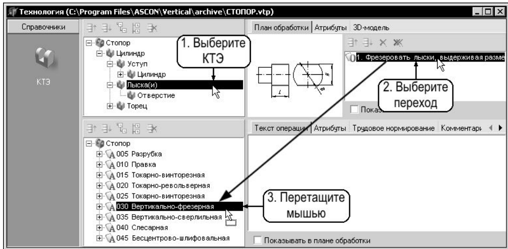
Рис. 6.2. Настройка связи между КТЭ и переходом из ТП
