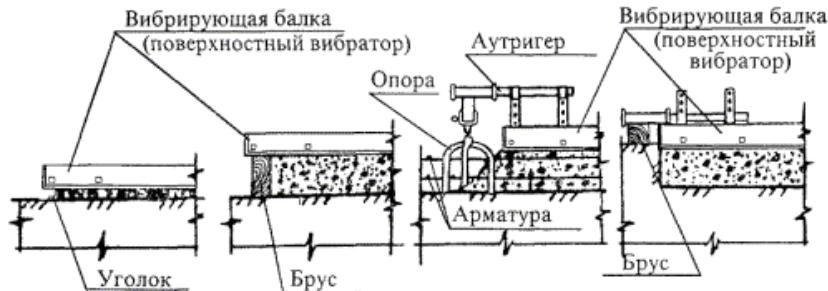
Рисунок 5 - Варианты установки опалубки и поддерживающих опор
