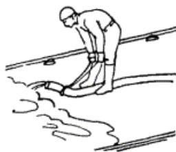
Бетонщик (B<sub>1</sub>), придерживая и перемещая шланг с помощью специальной скобы, подает бетонную смесь в карту и, постепенно отступая назад, распределяет бетон по всей ширине бетонируемой полосы.
