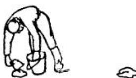
Затем бетонщик (B<sub>3</sub>) наполняет раствором ведро и, двигаясь вдоль разметки, раскладывает порции раствора через 1,5 м в местах установки направляющих реек.
