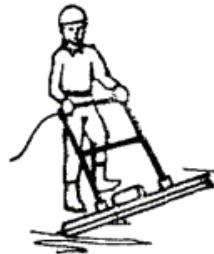
Бетонщик ( $B_5$ ) с помощью выравнивающего вибратора выравнивает поверхность бетона, устранивая метки от поперечных линий, возникающих при временных остановках выбирирующей балки, выравнивает небольшие впадины и выпуклости.
