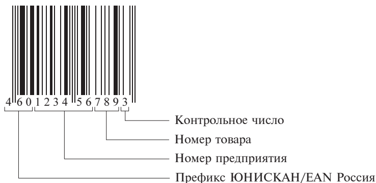
Рис. 6.8. Структура кода EAN-13 и его представление в штриховом виде для российского товара
