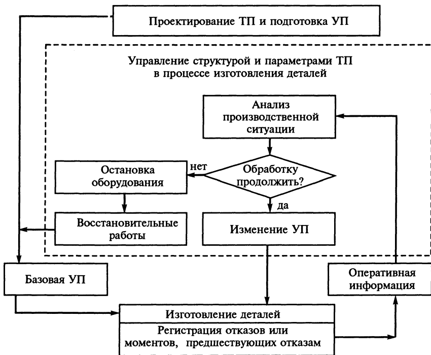
Рис. 6.14. Схема функционирования интегрированной системы проектирования ТП
