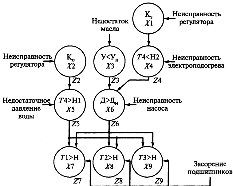
Рис. 3.42. Граф причинно-следственных связей системы смазки подшипников редуктора
