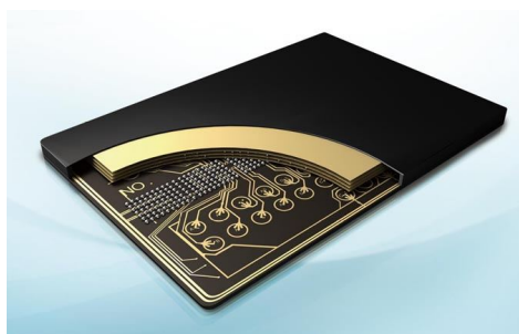
Корпус четырехуровневого модуля памяти 3DS TSV DRAM компании Samsung.
