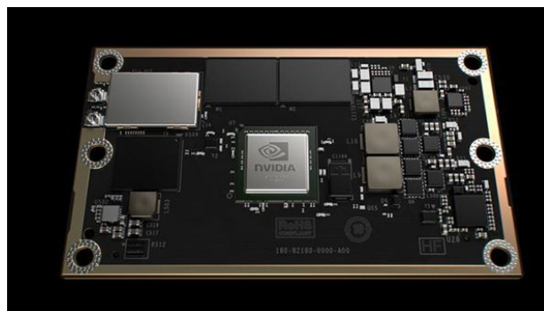
Рисунок 1. Выпущенный NVidia модуль Jetson TX1 имеет производительность суперкомпьютера и размеры кредитной карты.
