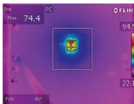
Рисунок 5. Тепловой портрет схемы при температуре окружающей среды 25 °С. ( V_{IN} = 5 В , V_{OUT} = 3.3 В/5 А ).
