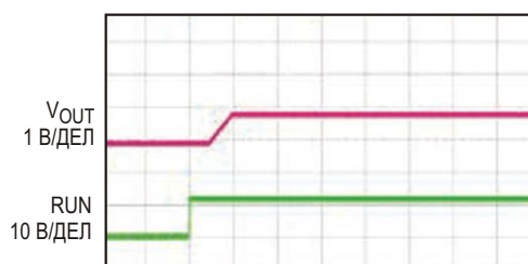
Рисунок 4. Пуск преобразователя, изображенного на Рисунке 1. ( V_{IN} = 12 В , V_{OUT} = 1.8 В/5 А ).
