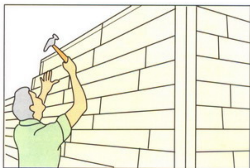
Рис. 92. Установка последующих рядов цокольного сайдинга
