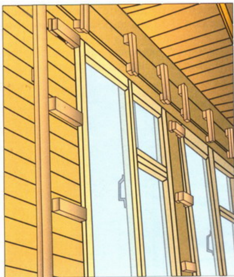
Рис. 13. Устройство обрешетки вокруг проемов
