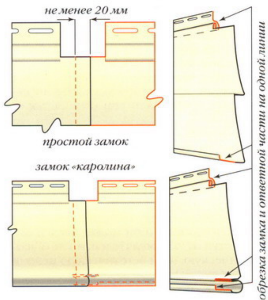
Рис. 52. Резка рядовых панелей сайдинга
