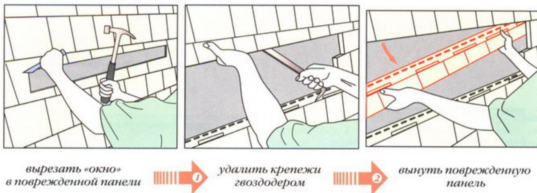
Рис. 98. Демонтаж рядовой цокольной панели
