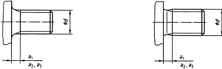
Bild 406.1 Abstand des letzten vollen Gewindeganges von der Anlagefläche (bei Teilen mit Gewinde annähernd bis Kopf) (Maße s. Tab. 407.1)
