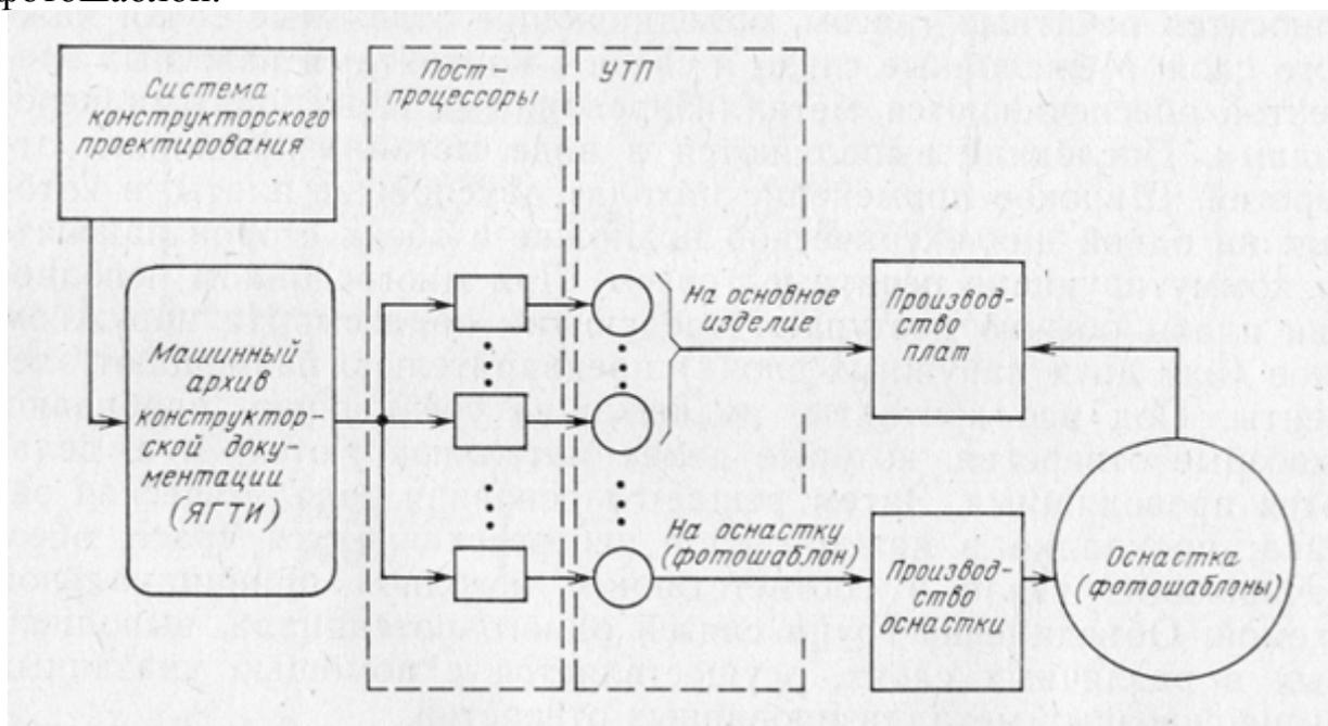
Рис. 31. Схема безбумажного обмена документацией при сквозном конструкторско-технологическом проектировании печатных плат
