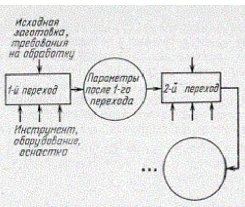
Рис. 26. Схема последовательного расчета межоперационных параметров
