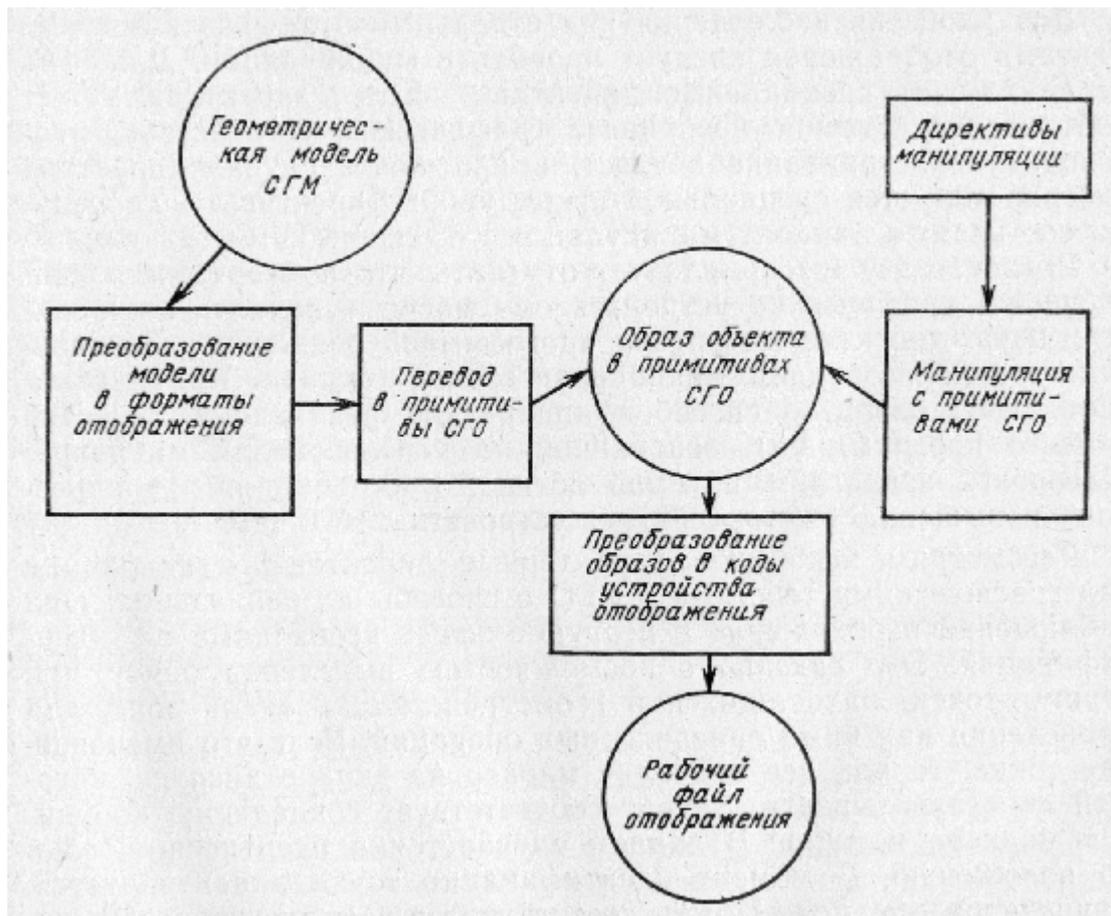
Рис. 5.18. Схема преобразования геометрической модели в изображение
