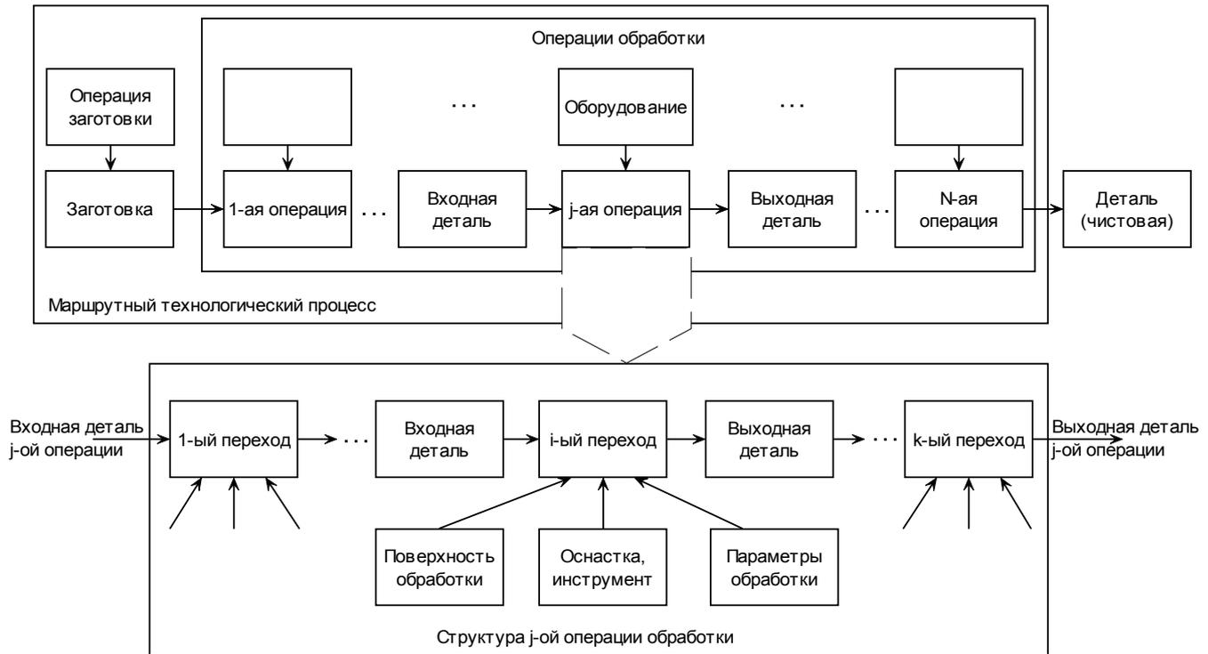
Рис. 24. Структура двухуровневого технологического процесса
