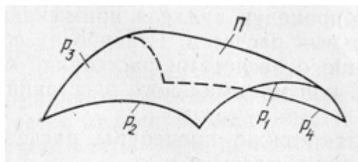
Рис. 8. Грань:  $P$  – поверхность носителя;  $P_i$  – обрамляющие ребра
