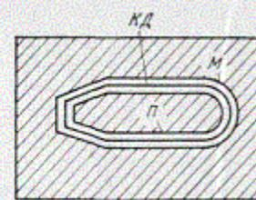
Рис. 33. Внешние контуры режущих кромок пуансона *П* и матрицы *М*; *КД* – кромка обрабатываемой детали
