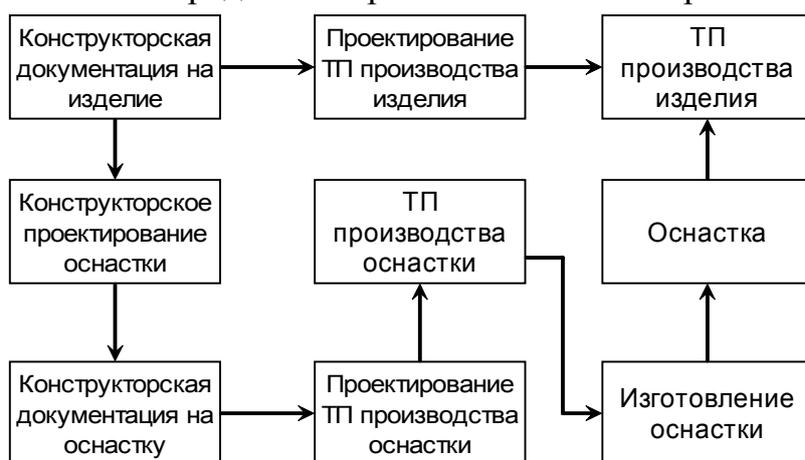
Рис. 23. Схема проектирования технологического процесса производства изделия с индивидуальной оснасткой
