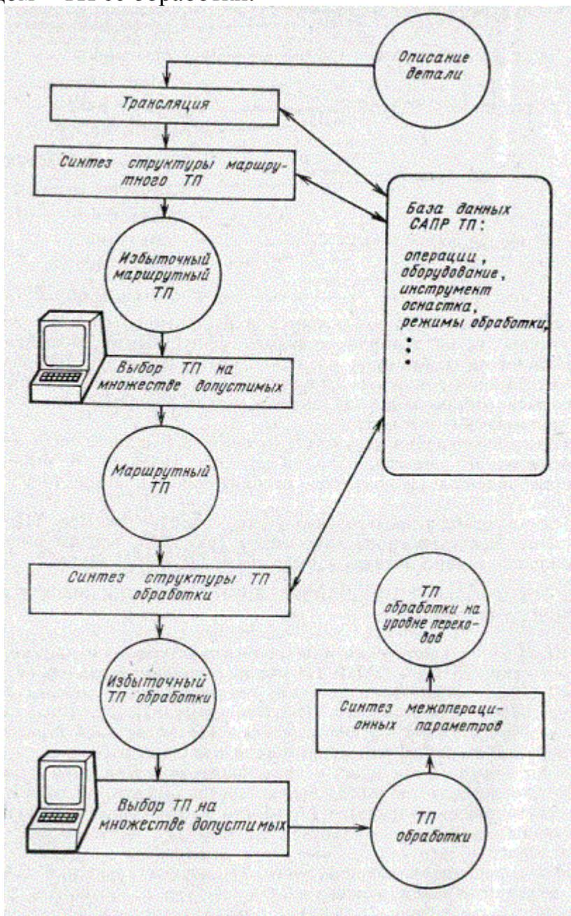
Рис. 27. Схема синтеза технологического процесса
