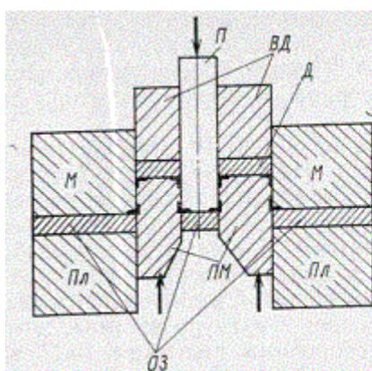
Рис. 34. Рабочие элементы пакета разделительного штампа совмещенного действия:
