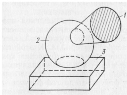
Рис. 9. Пример детали, образованной пересечением конуса 1, шара 2 и параллелепипеда 3
