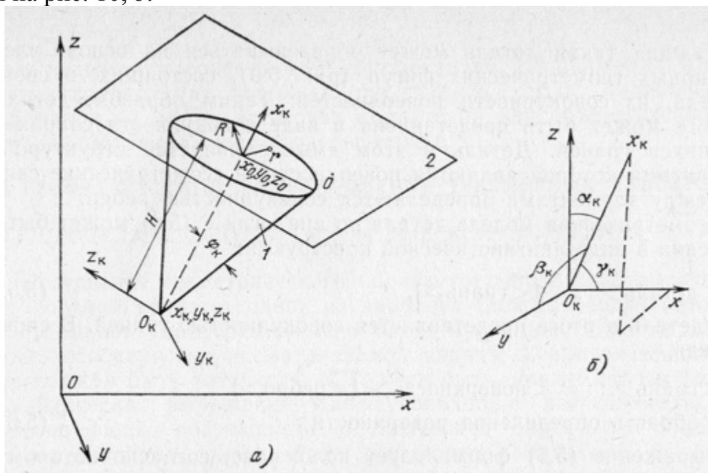
Рис. 10. Конус, образованный конической поверхностью 1 и плоскостью 2 (а) и система координат конуса (б)
