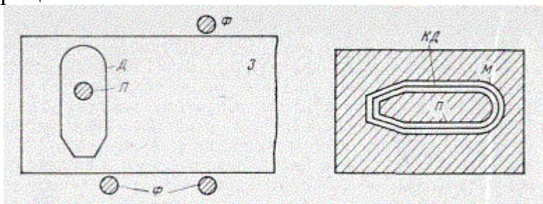
Рис. 32. Деталь *Д* с вырубкой полостью *П*, заготовка полосы материала *З* и ее фиксаторы *Ф* на рабочей плите
