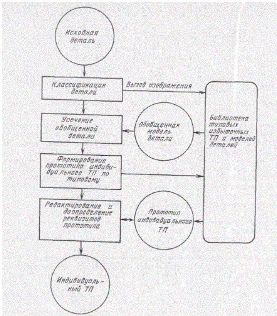
Рис. 29. Схема диалогового синтеза индивидуального технологического процесса по избыточному
