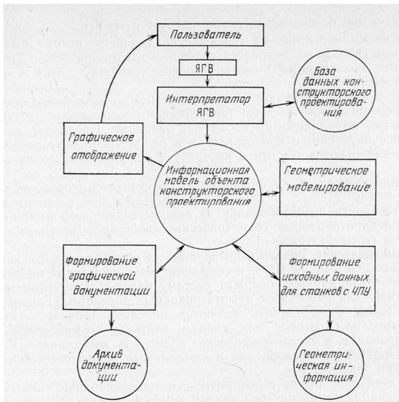
Рис. 1. Схема базового программно-информационного обеспечения конструкторского проектирования
