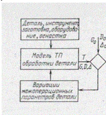
Рис. 25. Схема поиска межоперационных параметров детали
