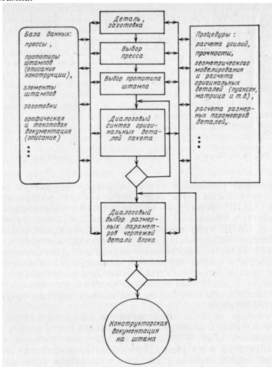
Рис. 37. Структура сценария диалогового автоматизированного конструирования штампа
