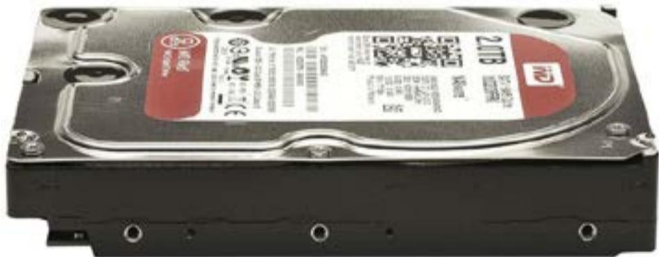
**А:** Для начала я бы отнес двухтерабайтник к компу, который не глючит и нормально работает с дисками, подключился к нему по SATA и попробовал поработать с инфой на WD20EFRX. Эксперимент наглядно и точно покажет, где нужно искать проблему. При этом следует учитывать, что на EFRX некоторые данные уже могут быть за-
