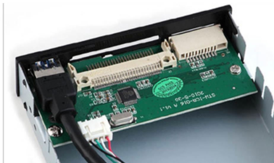
Один из кабелей заведует работой кардридера, а второй просто идет к розетке. В обоих кабелях есть четыре провода: красный (плюс питания, «+5V»), белый (сигнальный, «Data-»), зеленый (сигнальный, «Data+»), черный («земля», «Ground», «GND»). Электрически они друг с другом не связаны (разве что питающие провода могут быть объединены и может стоять общий фильтр из пары конденсаторов), и не-
