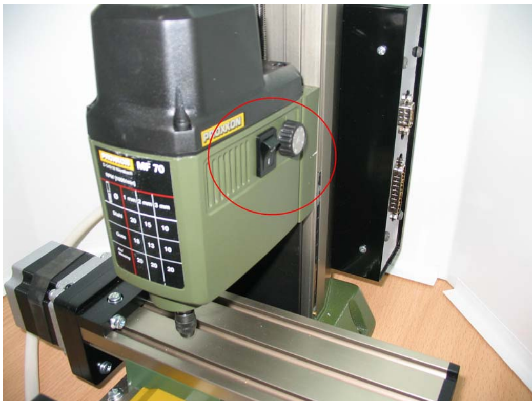
Рис. 53. Кнопка включения фрезерной головки, а также рукоятка изменения числа оборотов шпинделя
