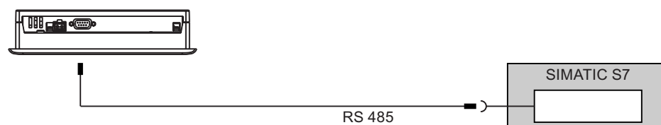
Рисунок 4-9 Подключение TP 177A к ПЛК
