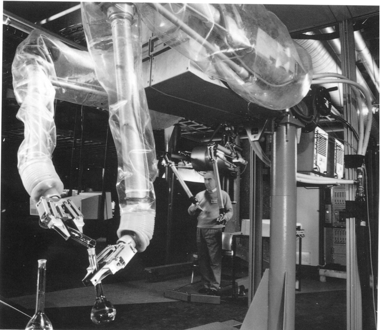
Рис.1.4. Копирующий манипулятор Маскот фирмы «Телеробот» (Италия).
