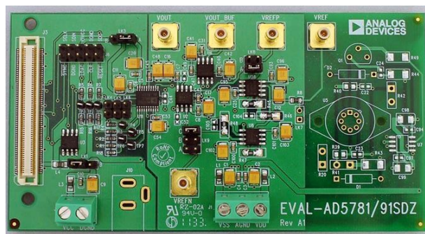
Рисунок 7. Отладочная плата для микросхемы AD5791.
