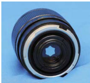
За свою форму диафрагма «Индустар-61 Л/3» получила прозвище «звезда ниндзя»
