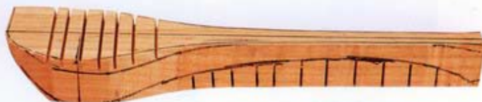
Третий этап Маркировка для удаления ненужных частей при помощи распилов
