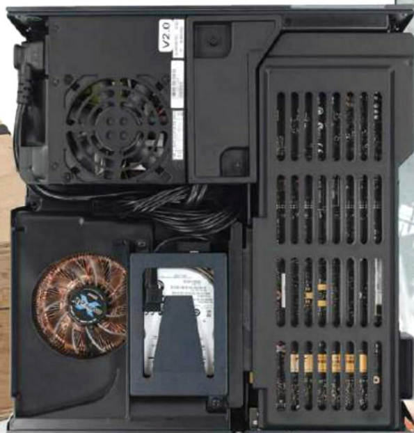
Внутренняя конструкция Steam Machine от Valve
