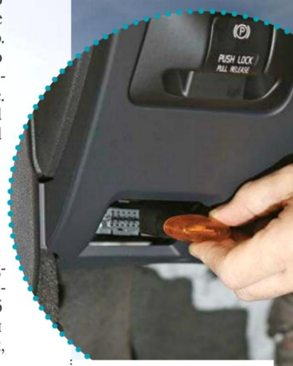
▲ Гнездо OBD-2 чаще всего расположено слева рядом с педалями у капота, снизу рулевой колонки или на боковой стенке
