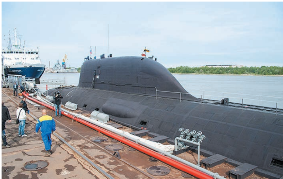
Новейшая атомная субмарина проекта 885 «Ясень». Первый корабль проекта, «Северодвинск», вошёл в состав Северного флота в 2014 г. Мощное вооружение: самонаводящиеся торпеды и крылатые ракеты дальностью до 800 км, — позволяют «Ясеню» одинаково эффективно поражать цели под водой, на воде и на суше. Корпус лодки изготовлен из маломангнитной стали и покрыт резиной, что делает «Ясень» невидимым для противника
