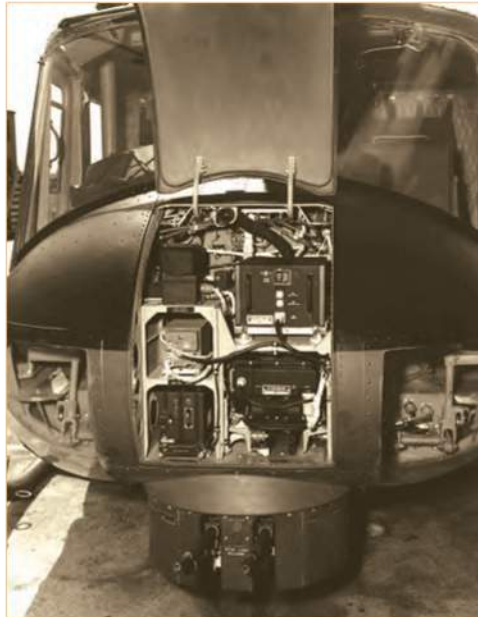
Вариант УН-1С для КМП с турелью ТАТ-101 (2 x 7,62-мм пулемета М60)
