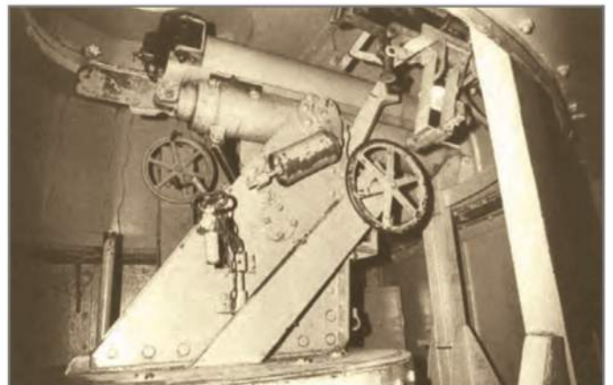
Тумбовая установка 76-мм орудия образца 1902/30 годов в башне бронеплощадки ПЛ-37
