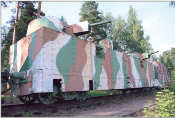
Модернизированная бронеплощадка ПЛ-35 (с установленными 76-мм орудиями образца 1902/30 годов, с длиной ствола 40 калибров). Военно-исторический музей, Парола, Финляндия
