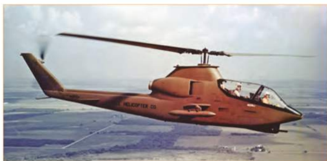
Опытный боевой вертолет «Кобра» в полете с убраным полозковым шасси
