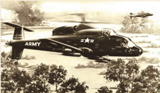
Рисунок варианта винтокрыла «Сикорский» S-66 с отдельными кабинами и Т-образным оперением
