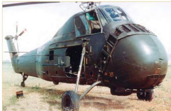
В проемах французского H-34 установлен 12,7-мм пулемет «Браунинг» и 20-мм пушка MG-151
