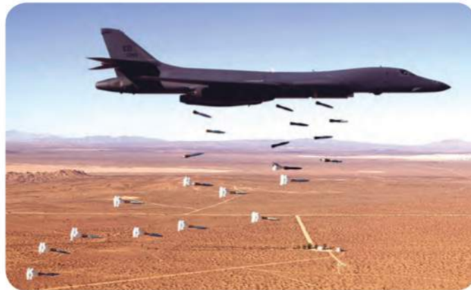
Самолет В-1В сбрасывает фугасные бомбы Mk.83AIR с парашютным тормозным устройством BSU-85/B, которое имеет режимы большого и малого сопротивления.
