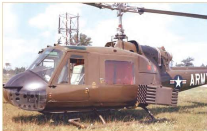
Вариант вертолета УН-1 с двумя блоками по 24 НАР калибра 70 мм
