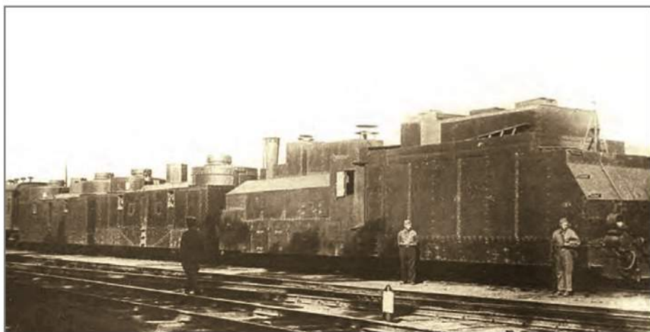
Легкий бронепоезд на ученьях, 1936 год. Впереди бронепаровоз типа склада № 60, за ним две бронеплощадки типа склада № 60 с орудийными башнями круглой формы
