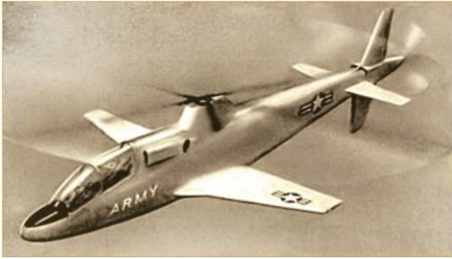
Рисунок винтокрыла «Сикорский» S-66 с кабиной летчиков под общим фонарем и стабилизатором на хвостовой балке
