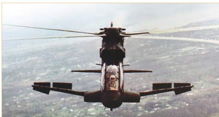
Вертолет S-67 «Блэкхок» («Blackhawk») с выпущенными тормозными щитками во время испытаний по оценке их эффективности
