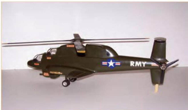
Демонстрационная стендовая модель винтокрыла «Сикорский» S-66 с отдельными кабинами и Т-образным оперением
