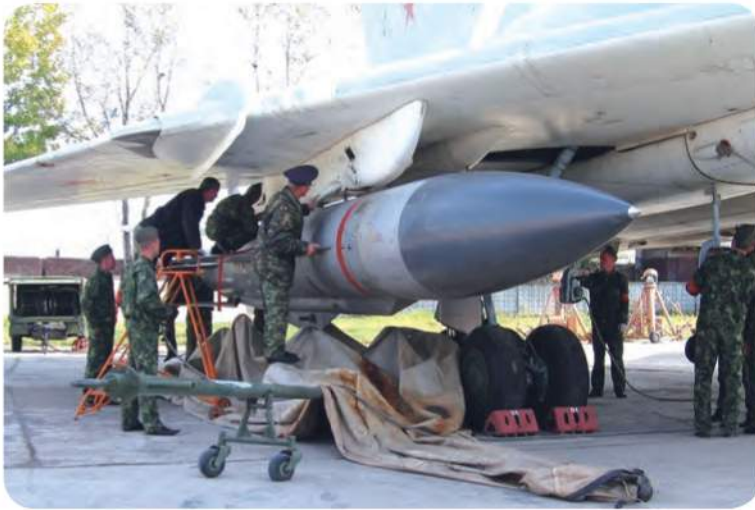
Подвеска ядерной крылатой ракеты X-22НА с автономной инерциальной системой наведения на держатель БД-45К самолета Ту-22МЗ российской Дальней авиации.
