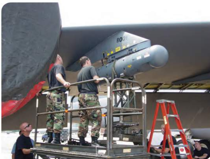
Контейнер LITENING с телекамерой, тепловизором и лазерным целеуказателем, обеспечивает применение лазерных бомб с борта B-52H без внешней подсветки.
