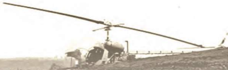
Вертолет Н-19, оснащенный пусковыми устройствами для НАР, в Корее, на заднем плане легкий Н-13
