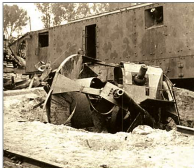
Сорванная взрывом с бронеплощадки ПЛ-35 башня с 76-мм орудием образца 1902 года
