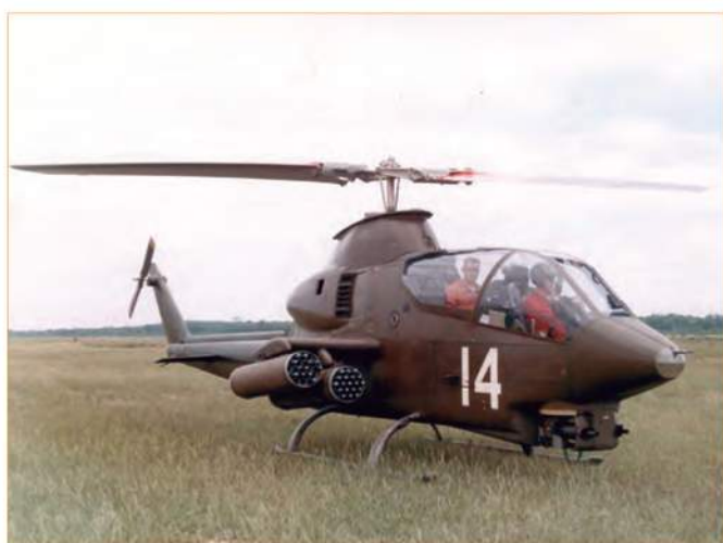
Боевой вертолет AH-1G «Хью Кобра» с неубираемым полозковым шасси, двумя 40-мм автоматическими гранатометами и четырьмя блоками по 19 НАР
