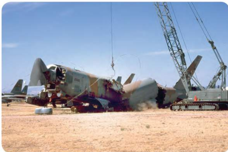
Разделка с помощью падающей бетонной плиты списанного бомбардировщика B-52G-120-BW S/N 59-2580 на авиабазе Девис Монтан. Фото: Airliners.net
