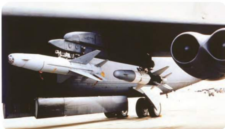
Для поражения точечных сильно защищенных целей самолеты B-52G и H пытались вооружать ракетами AGM-142 «Хэв Нэп» («Папай») разработки израильской фирмы «Рафаэль».
