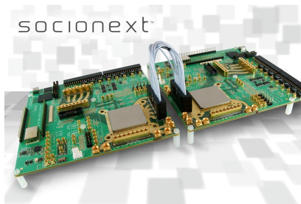
Наборы разработчика Rotta (АЦП) и Oola (ЦАП), спроектированные и изготовленные компанией Socionext в рамках проекта Celtic-Plus SASER.
