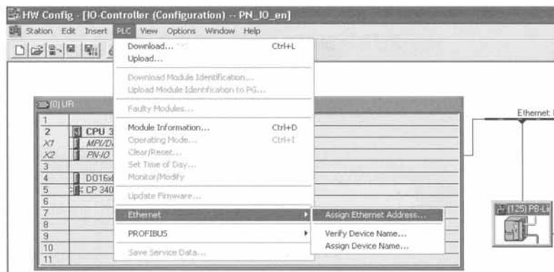
Рис. 4.39 Назначение Ethernet-адреса с помощью утилиты HW-Config
