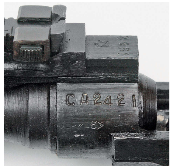
Серийный номер на винтовке АВТ, изготовленной на Медногорском оружейном заводе №314 НКВ в 1942 г.
