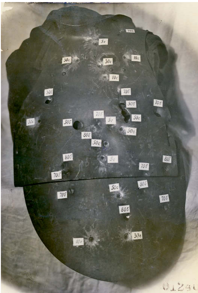
Вид стального нагрудника СН-42 со следами попаданий пуль. Цифрами обозначены дистанции стрельбы в метрах. Индекс «б» означает пулю со стальным сердечником, индекс «с» – пулю со свинцовым сердечником
