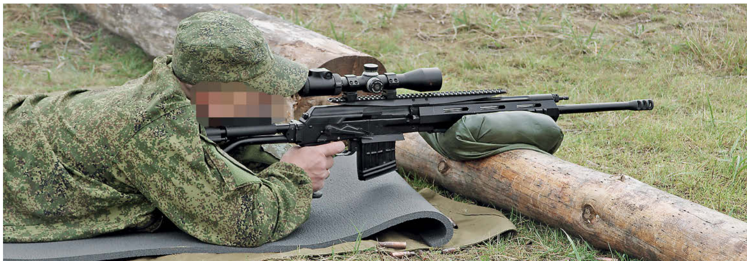
ВПО-129 калибра 7,62x54 предполагает использование штатных магазинов от СВД, вмещающих 10 патронов. На фото изображена винтовка со складывающимся металлическим прикладом постоянной длины и регулируемой щекой
