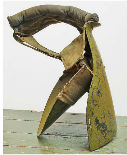
Использование СН-42 в качестве стрелкового щита (на грунте нижняя панель выполняет роль сошника)
