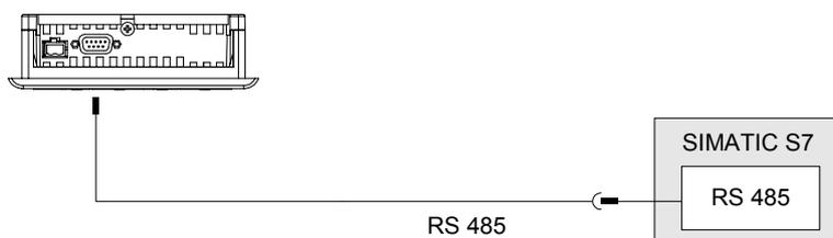
Рисунок 4-15 Подключение ПЛК к OP 77A
