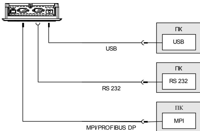
Рисунок 4-18 Подключение компьютера проектирования к OP 77B
