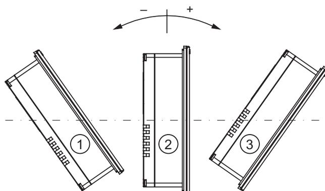
Рисунок 3-1 Допустимые положения при монтаже
