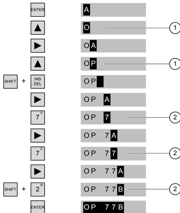
Рисунок 8-6 Пример ввода с использованием клавиш управления курсором и цифровой клавиатуры
