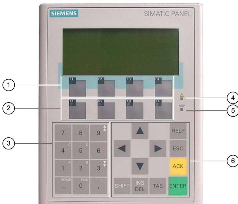
Рисунок 5-2 Элементы операторского управления и светодиодные индикаторы
