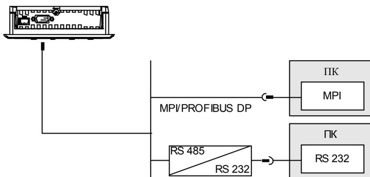
Рисунок 4-17 Подключение компьютера проектирования к OP 77A
