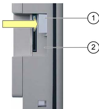
Рисунок 5-7 Вставка полосок маркировки
