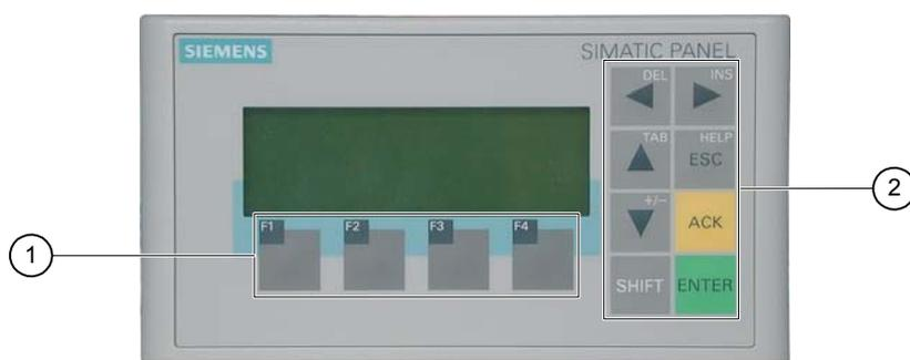
Рисунок 5-1 Элементы операторского управления и светодиодные индикаторы
