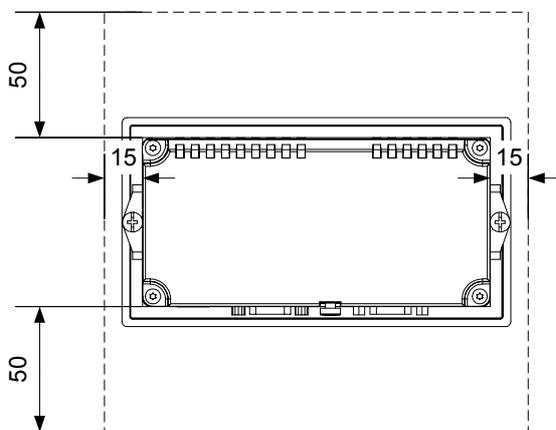
Рисунок 3-5 Зазоры между ОР 73 и монтажным вырезом
