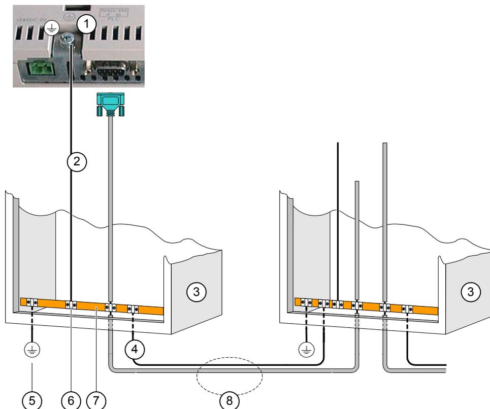
Рисунок 4-14 Монтаж цепи эквипотенциального заземления
