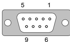
Рисунок 12-5 Назначение контактов интерфейса RS 485
