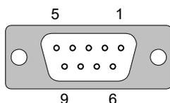
Рисунок 12-4 Назначение контактов интерфейса RS 485
