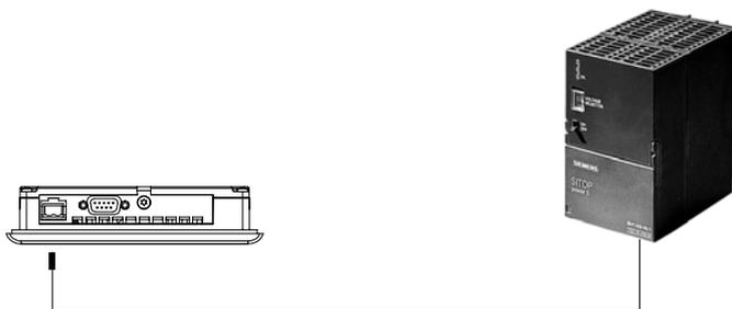
Рисунок 4-6 Подключение источника питания
