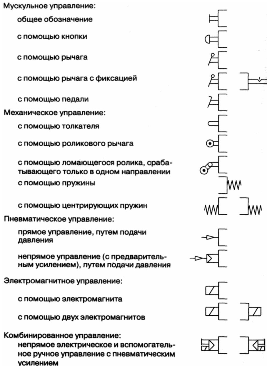
Рис. 3.5. Способы управления распределителями
