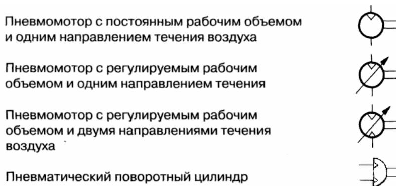
Рис. 3.10. Исполнительные устройства вращательного действия
