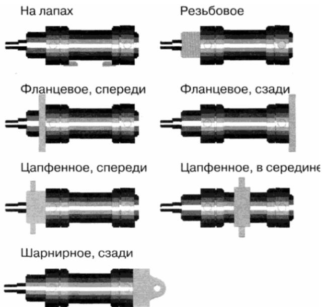
Рис. 3.16. Способы крепления цилиндров
