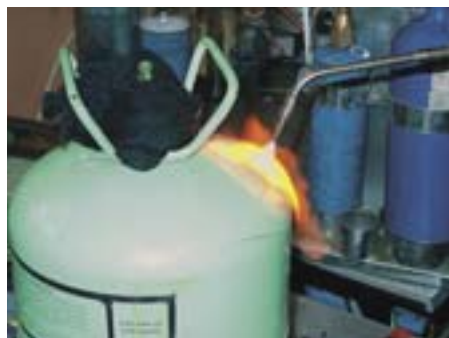
Нагрев места, где будет сделано отверстие
