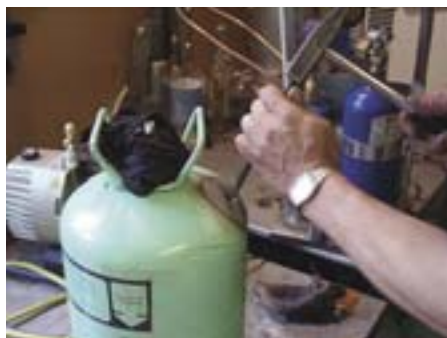
Только керном. Сверлить нельзя, иначе попадет стружка
