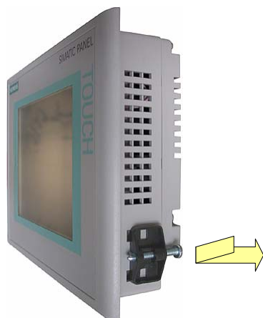
Рисунок 4-11 Установка винтовых зажимов на устройстве НМІ
