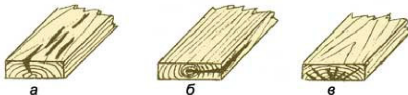
Рис.1 Разновидности трещин: а – пластевые; б – кромочные; в – торцовые
