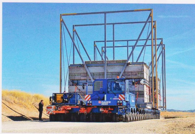
ПОДГОТОВКА 104-КИЛОМЕТРОВОГО «ПУТИ ITER» обошлась Франции в €110 млн и четыре года работы. Дорога от порта Фос-Сюр-Мер до Кадараша была расширена и усилена, чтобы по ней можно было доставить на площадку самые тяжелые и габаритные детали токамака. На фото: транспортёр с тестовым грузом массой 800 т.
