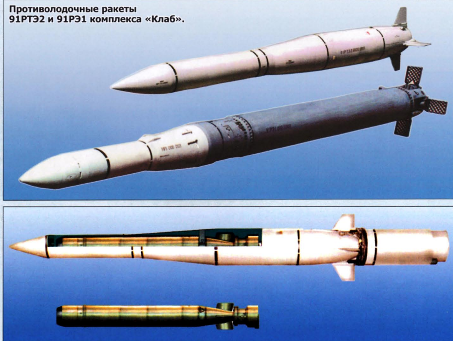
Общий вид торпеды МПТ-1УМЭ и ее размещение в качестве боевой части в ракете 91РТЭ2.
