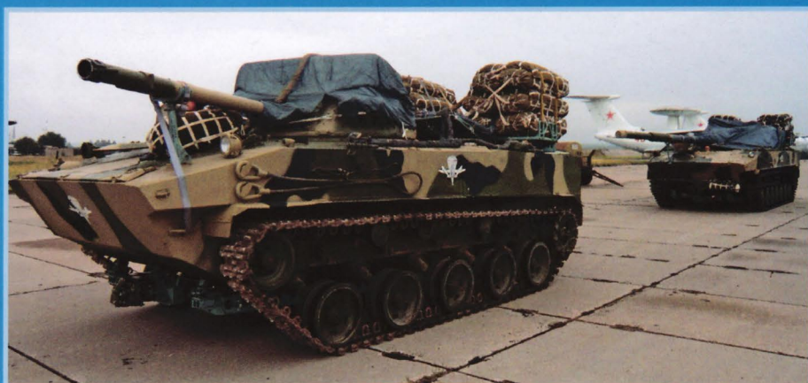
Боевая машина десанта БМД-4М со средствами десантирования ПБС-950У («Бахча-У-ПДС»). На заднем плане – СПТП «Спрут-СД» со средствами десантирования «Спрут-ПДС».
