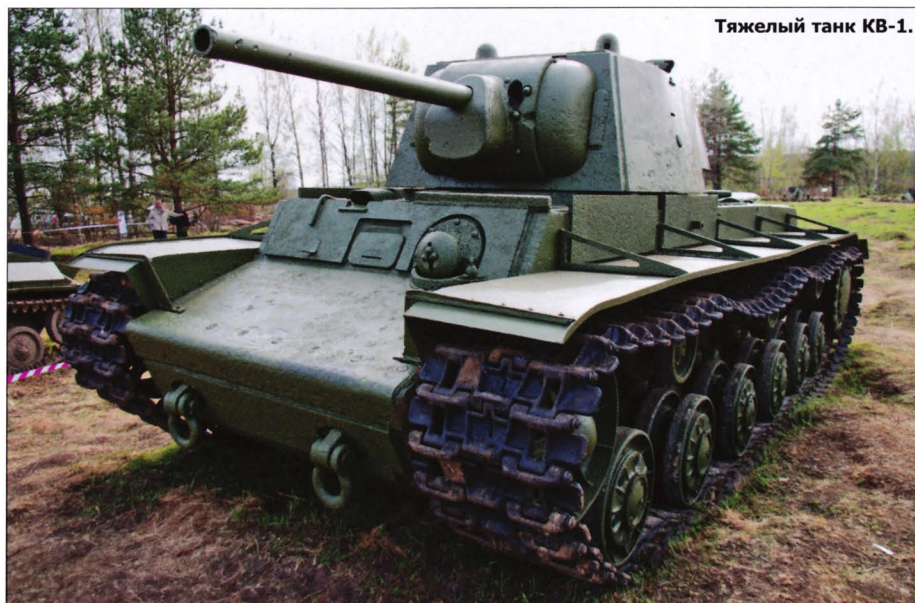
90-мм борт башни и 75-мм кормовая часть танка КВ-1.
