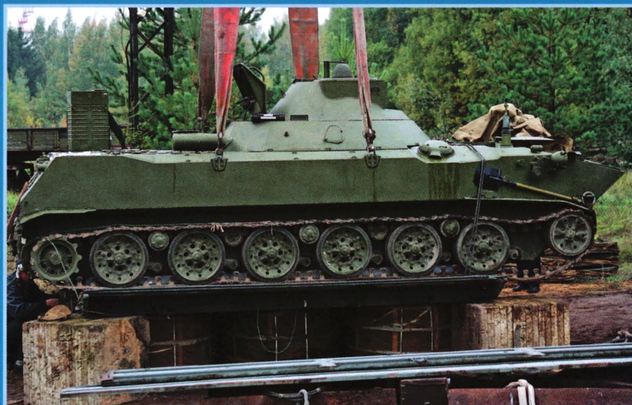
Модернизированный передвижной пункт разведки и управления огнем артиллерии 1В119-1 «Реостат-1» на копровых испытаниях.
