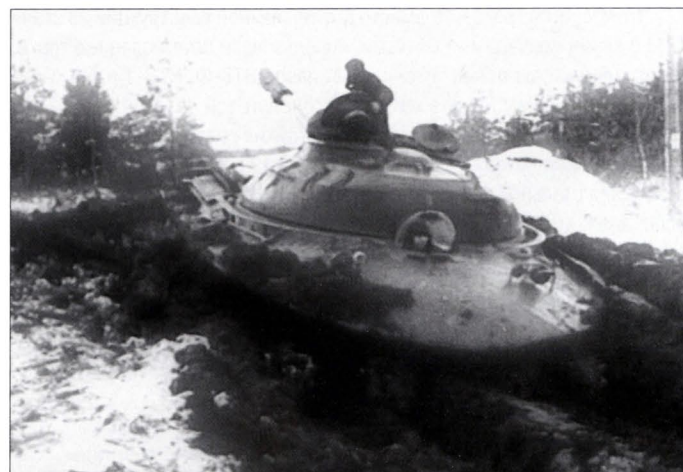
Сравнительные испытания танка «Объект 279» (образец №2) на проходимость, 1960 г.
