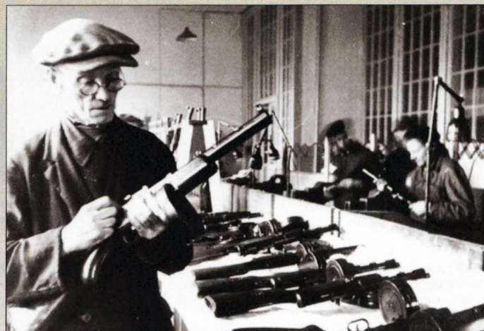
Контрольный мастер филиала Сестрорецкого инструментального завода им. Воскова С.В. Пивоваров осматривает собранный пистолет-пулемет ППД.
