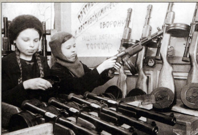
Юные работницы филиала Сестрорецкого инструментального завода им. Воскова Нина Николаева и Валя Волкова на сборке пистолетов-пулеметов ППД (с откидным прицелом).
