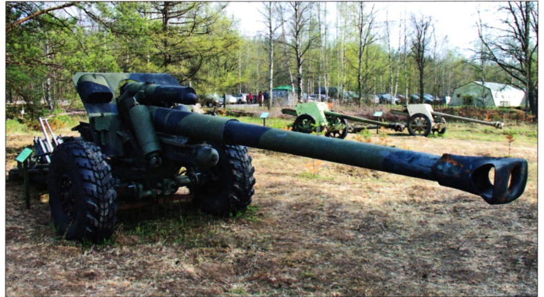
Модернизированная 150-мм немецкая тяжелая полевая гаубица sFH18 (финское обозначение - 152 Н 88-40).
