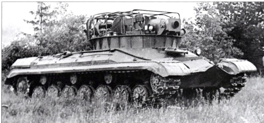
Испытания экспериментального образца механизма заряжания танка «Объект 279», смонтированного на танке «Объект 265» при снятой башне, 1957 г.
