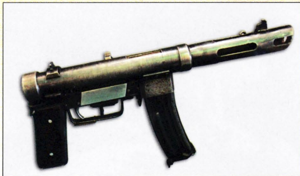
Укороченный пистолет-пулемет, изготовленный во время обороны Ленинграда в войсковых мастерских с использованием деталей ППД и ППШ.
