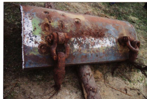
90-мм борт башни и 75-мм кормовая часть танка КВ-1.
