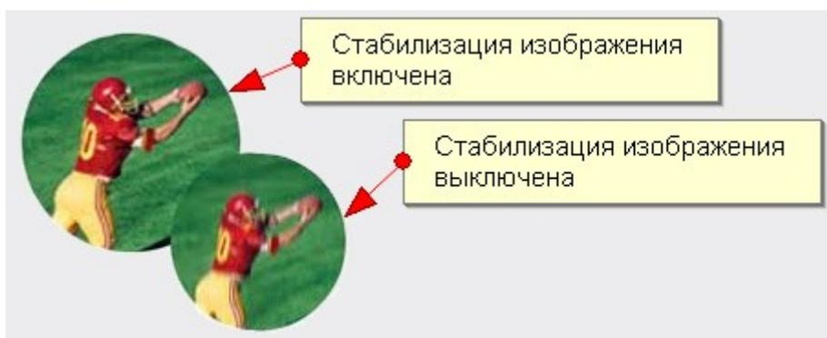
Система стабилизации изображения уменьшает «шевеленку», которая возникает при смещении камеры во время съемки при низком освещении или с помощью длиннофокусных объективов. Если в вашей камере отсутствует система стабилизации изображения, вам скорее всего захочется приобрести объектив, в котором она есть особенно это касается телеобъективов.
