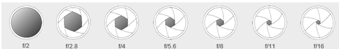
Диафрагма объектива — еще один важный параметр при выборе. Она позволяет изменять количество проходящего через объектив света, что определяет соотношение яркости оптического изображения фотографируемого объекта к яркости самого объекта, а также устанавливать необходимую глубину резкости. Диафрагма может быть указана несколькими способами: F4, f/4, 1:4 — все они означают одно и то же. Чем меньше число, тем больше диафрагма, т.е. Тем больше света пропускает объектив.
