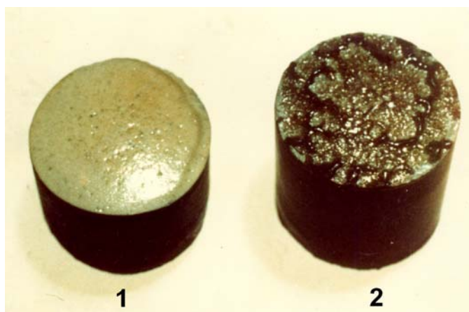
Рис. 4.15. Внешний вид образцов легированной КСК с различной вязкостью расплава после испытаний в дозвуковой струе ЭДП: 1 – \text{Cr}_2\text{O}_3 добавлен в мелкодисперсном виде; 2 – пропитка ангидридом хрома
