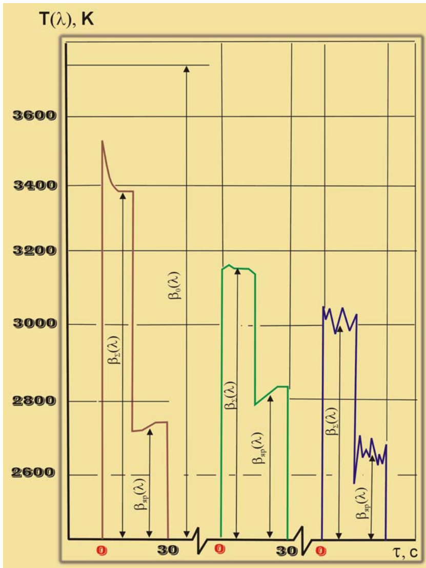
Рис. 4.19. Зависимость яркости (по температурной шкале пирометра) излучения образцов ТЗМ в процессе разрушения их поверхности от времени нагрева: 1 – чистая КСК, 2 – легированная КСК, 3 – асботекстолит АП
