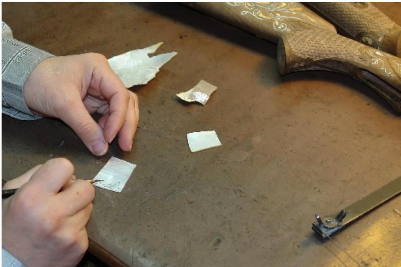
Вырезанные пластины перламутра я на точиле обдираю до толщины 2 мм. Они становятся более ровными и плоскими. Их удобно зажимать и обрабатывать.
