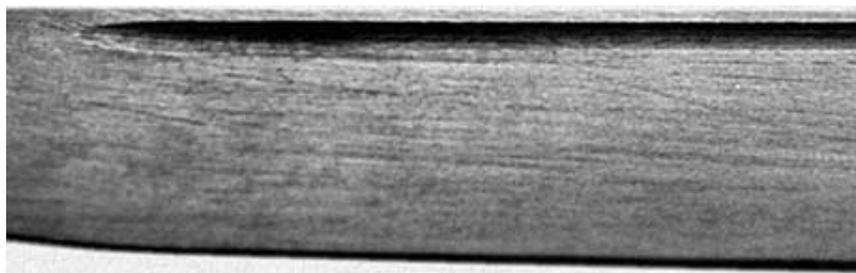
Уже предварительная шлифовка выявляет скрытые бугры и ямы, которые, как правило, сконцентрированы у острия и порожков полосы, т. е. там, где равномерное движение по абразивному кругу нарушалось из-за смены направления и силы прижима.
