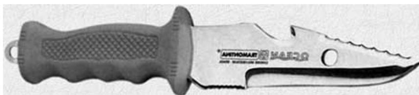
Однако самыми массовыми и, безусловно, самыми удобными из всех были и будут формы с расширением в средней части, симметричные или односторонние. И те, и другие применяются в любых разновидностях ножей и кинжалов, как прямых, так и кривых. Разумеется, прямой обоюдоострый клинок предполагает также симметричную соосную рукоять.
