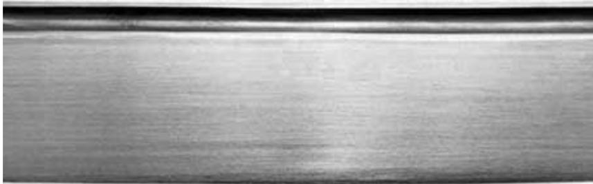
Окончательная доводка пастами должна привести к образованию идеального зеркала, отражающего любой предмет без каких-либо искажений его формы.
