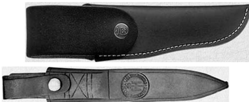
Конструктивно края кожи соединяются посредством прошивки, заклепок, оплетки кожаными же шнурком. Из всех этих способов действительно долговечным представляется лишь второй: мы должны быть готовы к тому, что тонкое лезвие рано или поздно прорежет шов изнутри, воспрепятствовать чему способен лишь металл. В идеальном случае это латунь, так как стальные заклепки ржавеют и могут тупить
