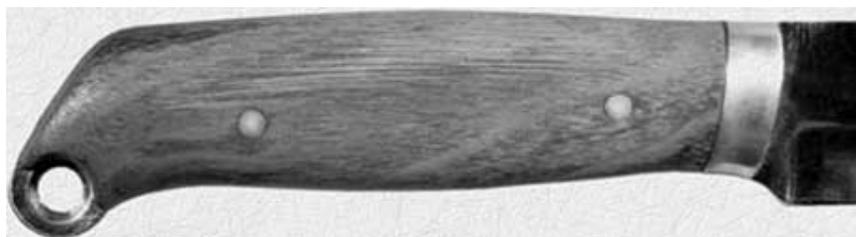
Разумеется, никто еще не дал правильного ответа, потому что это виноградная лоза. Сия окультуренная лиана обладает интересной структурой, напоминающей плотно спрессованные волосы. Она дает внушительную (примерно вдвое) усадку при сушке, зато становится твердой и хорошо принимает полировку. Чтобы выявить текстуру, готовую рукоятку следует пропитать льняным маслом, а особо рыхлые места — эпоксидной смолой, с последующей шлифовкой и полировкой.
