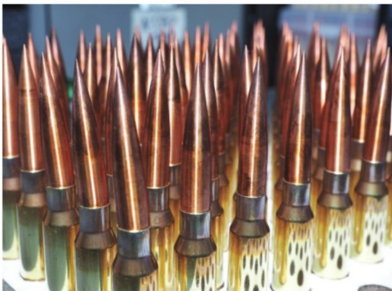
Производя высокоточные винтовки не самых распространённых калибров, «Лобаев армс» позаботился об их владельцах, предлагая патроны собственной сборки, позволяющие полностью раскрыть потенциал высокоточного оружия. На фото подсорти патронов калибра .408 Chey Tac перед монтажом пули
