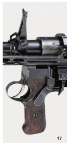
17. Слева над рукояткой ПТР M.SS41 находится рычаг предохранителя.
