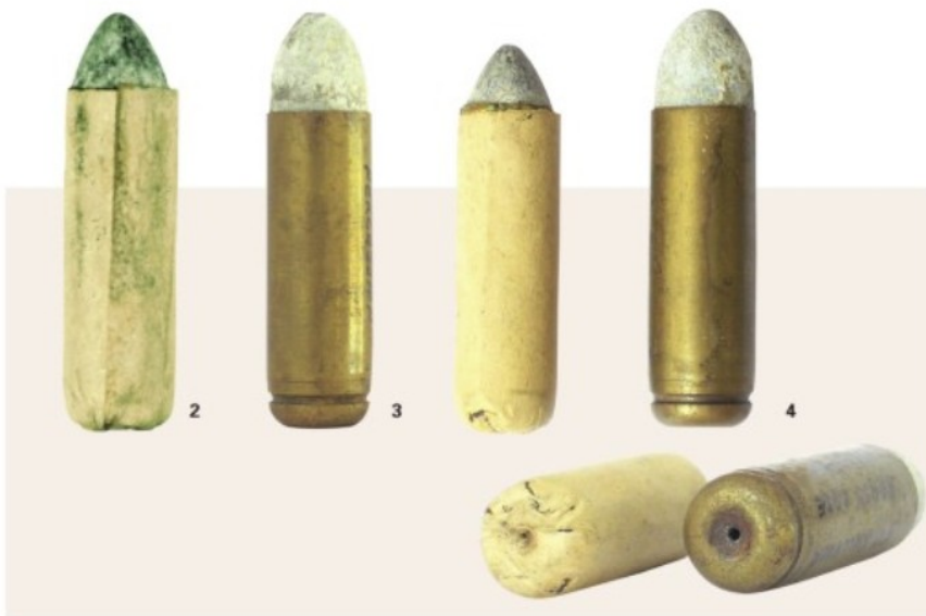
2. Изготовленный на основании патента Силаса Криспина оригинальный патрон Малхона Д. Галлагера с бумажной гильзой. Бумажные патроны встречаются крайне редко. 3. Более поздний, но чаще встречающийся патрон Галлагера с латунной гильзой. Данный патрон был принят на вооружение военным ведомством США во время гражданской войны вместе с карабином Галлагера обр. 1861 г. 4. Слева: ещё один бумажный патрон Галлагера из первых серий. Справа: более поздний «усовершенствованный» вариант с латунной гильзой. Все изображённые на фотографии патроны имеют калибр 12,7 мм. По слухам, также производился револьверный патрон калибра 9,14 мм (0,36"). Канавка у донца служила для удобства извлечения стреляной гильзы из патронника. Снизу, вид сзади: хорошо видны затравочные отверстия.
