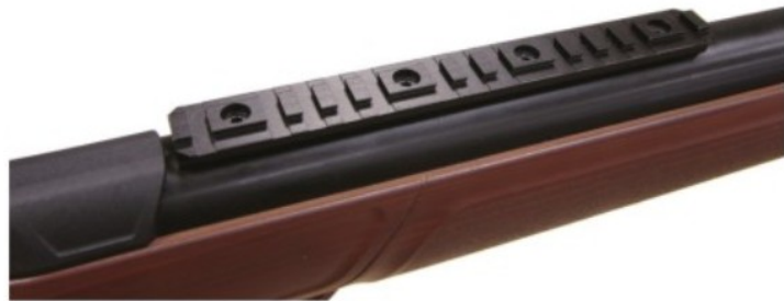
Комбинированная прицельная планка винтовки Smersh 125. Хорошо видны выступы, формирующие дискретный «ласточкин хвост». Справа компактное заднее прицельное приспособление модели Smersh
