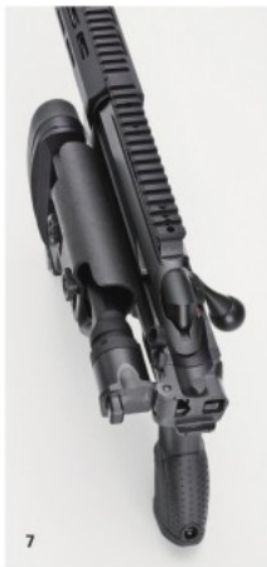
7. Регулируемый приклад модели Tikka T3x TAC A1 может складываться на левую сторону алюминиевого шасси. 8. На нижней стороне приклада находится короткая планка «пикатини» для установки упора приклада.
