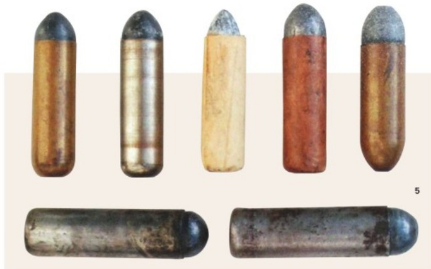
5. В верхнем ряду на фотографии изображены прототипы патронов Галлагера из коллекции доктора Георга Приштеля. Слева направо: патрон с медной гильзой; патрон с оцинкованной медной гильзой; патрон с бумажной гильзой; патрон с медной гильзой, имеющей закруглённые края донца; патрон с укороченной медной гильзой, имеющей скруглённое донце. Снизу, вид сбоку: слева – патрон с оцинкованной металлической гильзой; справа – патрон с оцинкованной медной гильзой.
