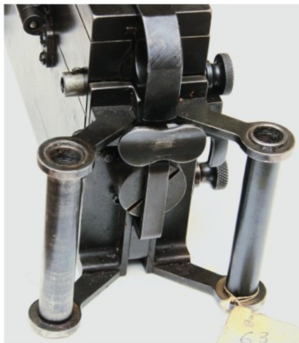
Затыльник ствольной коробки пулемёта 5.П. II с рукоятками управления огнём и спусковым рычагом
