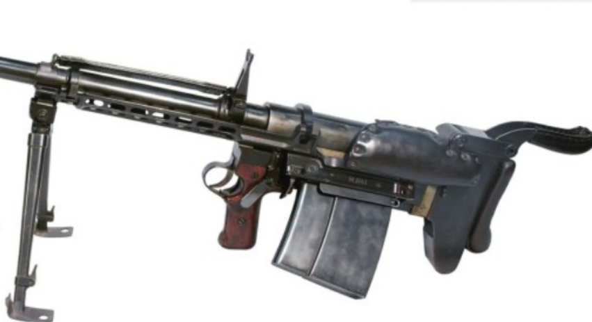
17. Слева над рукояткой ПТР M.SS41 находится рычаг предохранителя.
