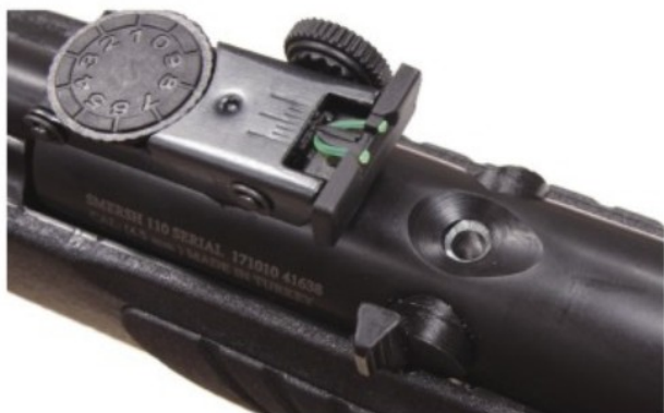
Пулеприёмник кранового типа винтовки Smersh 110 поворачивается с помощью флажка с левой стороны воздушного цилиндра. Для облегчения досылания пули в его камеру на цилиндре сделана воронка
