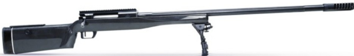
Рекордные стрельбы проводились со специально подготовленной винтовкой СВЛК-14 «Сумрак» оригинальным патроном калибра .40 Lobaev Improved с 28-граммовой пулей (в основе пережатая гильза патрона .408 Chey Tac). У винтовки удлинённый до 935 мм ствол с нестандартным шагом нарезов (254 мм) и смещённый влево регулируемый (тах 400 MOA) кронштейн с оптическим прицелом фирмы March (увеличение \times 5-40 )
