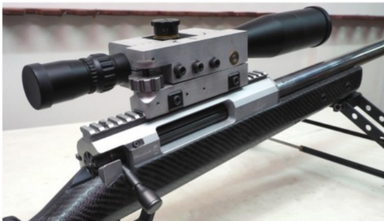
Рекордные стрельбы проводились со специально подготовленной винтовкой СВЛК-14 «Сумрак» оригинальным патроном калибра .40 Lobaev Improved с 28-граммовой пулей (в основе пережатая гильза патрона .408 Chey Tac). У винтовки удлинённый до 935 мм ствол с нестандартным шагом нарезов (254 мм) и смещённый влево регулируемый (тах 400 MOA) кронштейн с оптическим прицелом фирмы March (увеличение \times 5-40 )
