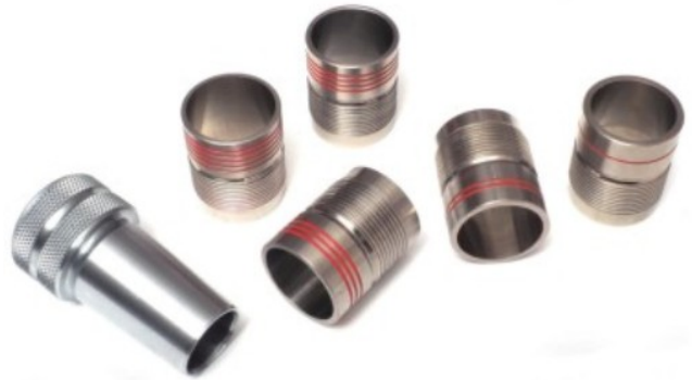
Ружьё комплектуется пятью сменными дульными насадками длиной 26 мм (!), со стандартными сужениями от «цилиндра» до полного чока, без идентификационных рисок на дульном срезе под ключ фрикционного типа. Кольца красного цвета на корпусах насадок — маркировка по степени сужения: 5 колец — «цилиндр» (18,4 мм), одно кольцо — чок (17,4 мм)
