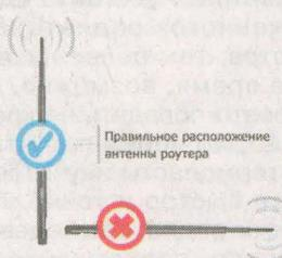
правильное расположение оборудования. Следует разместить wifi роутер в центре комнаты или помещения на высоком месте – шкаф или стена над дверным проемом. Внешние антенны беспроводного маршрутизатора должны располагаться так же, как и антенны приемных устройств. Ввиду того что в ноутбуках приемники размещены в рамке экрана, рекомендуется установить антенну роутера в вертикальное положение.
