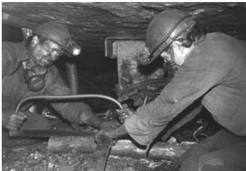
Рис. 218. Подготовка к срочному креплению свода забоя — «Успей, пока не задавило!». Изобразительные средства: уравновешенность, момент съемки, равномерное заполнение площади изображения. Фото Ю. Чоботова
