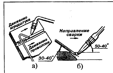
рис. 3.24. Правая сварка: а - схема движения мундштука и горелки; б - углы наклона мундштука и проволоки.
