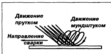
рис. 3.25. Сварка ванночками.
