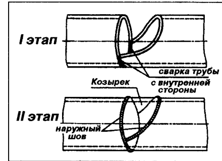
рис. 3.33. Порядок сварки стыков труб с козырьком.
