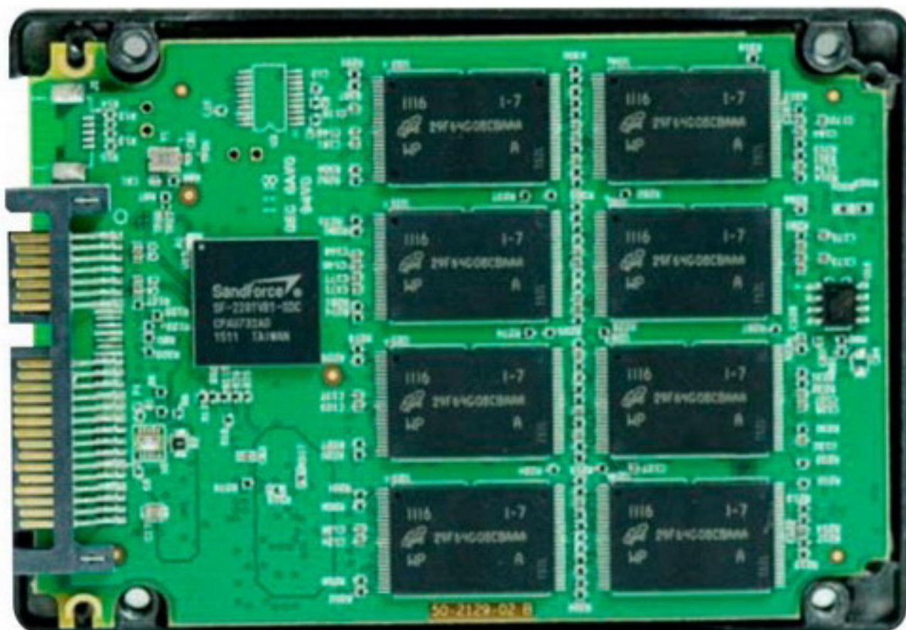
УПОМЯНУТЫЙ SandForce SF-2281: всего лишь ещё одна крохотная микросхема
