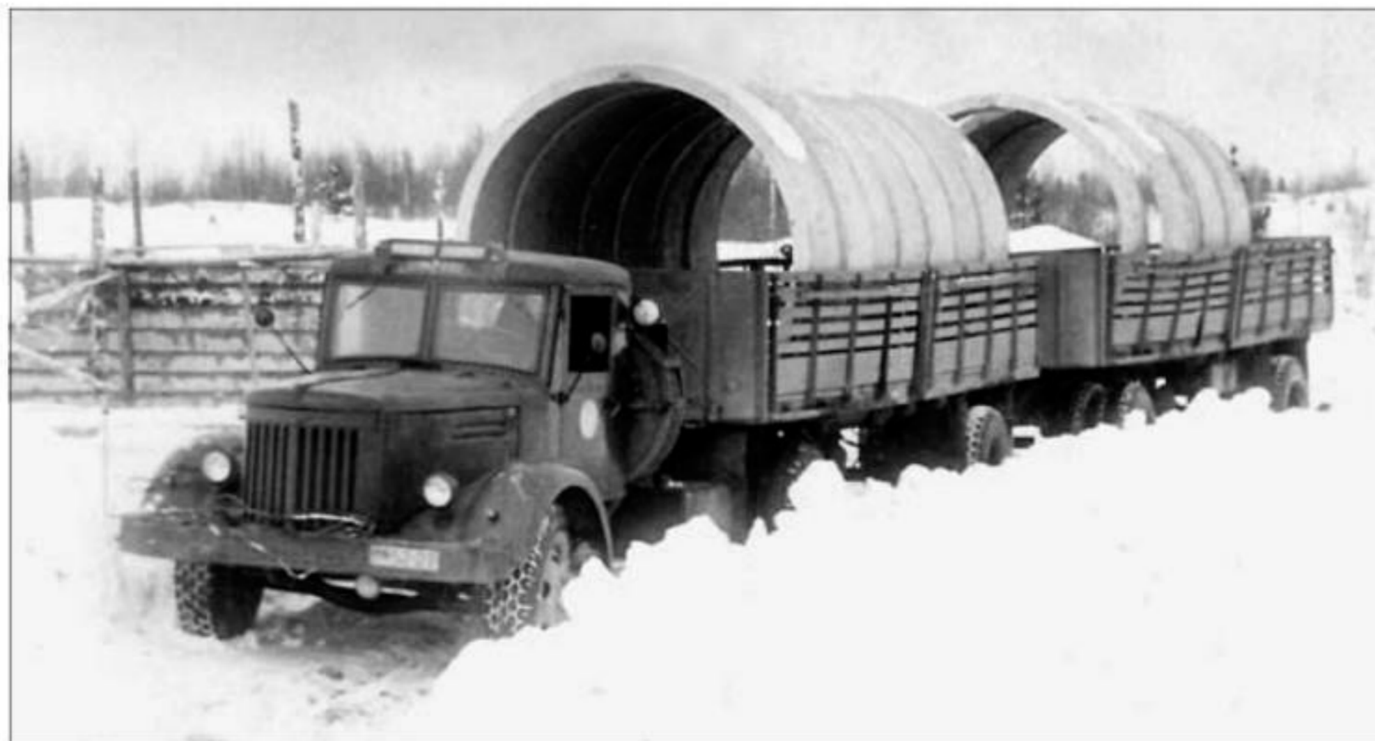
Транспортировка элементов К-1 комплекта СБК на автомобиле ЯАЗ-210 с прицепом; справа – общий вид элементов К-1.
