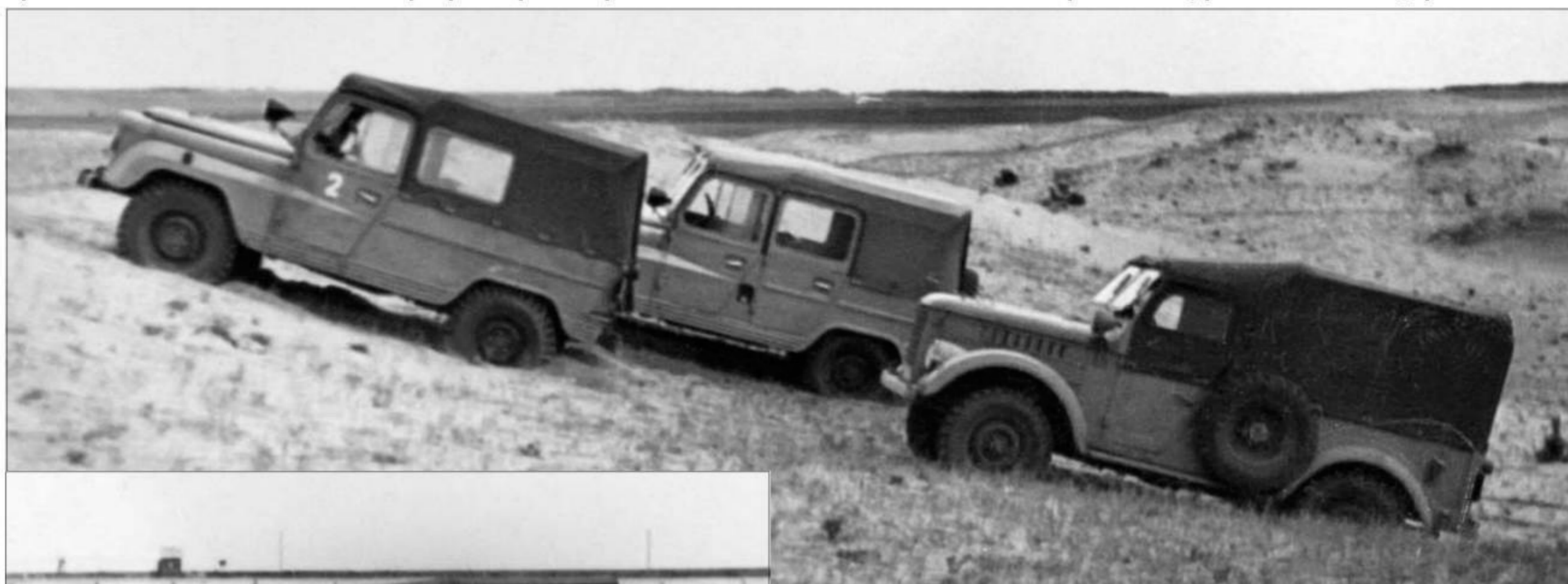
Определение максимального угла подъема на песке, при котором колеса автомобиля начинают буксовать. Слева-направо: УАЗ-469, УАЗ-460Б и ГАЗ-69.
