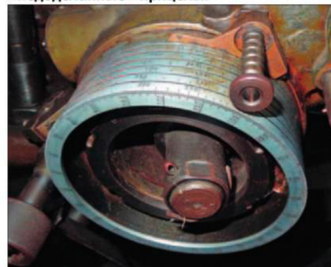
Дистанционный барабан прицела гаубицы М-30 №6821 имеет уже все положенные дистанционные шкалы.
