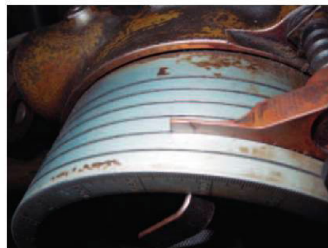
Дистанционный барабан прицела гаубицы М-30 №2464 только со шкалой тысячных, без дистанционных шкал. Из-за эвакуации смежника – приборостроительного завода ряд гаубиц М-10 и М-30, выпущенных на рубеже 1941–1942 гг., получили такие «недоделанные» прицелы.
