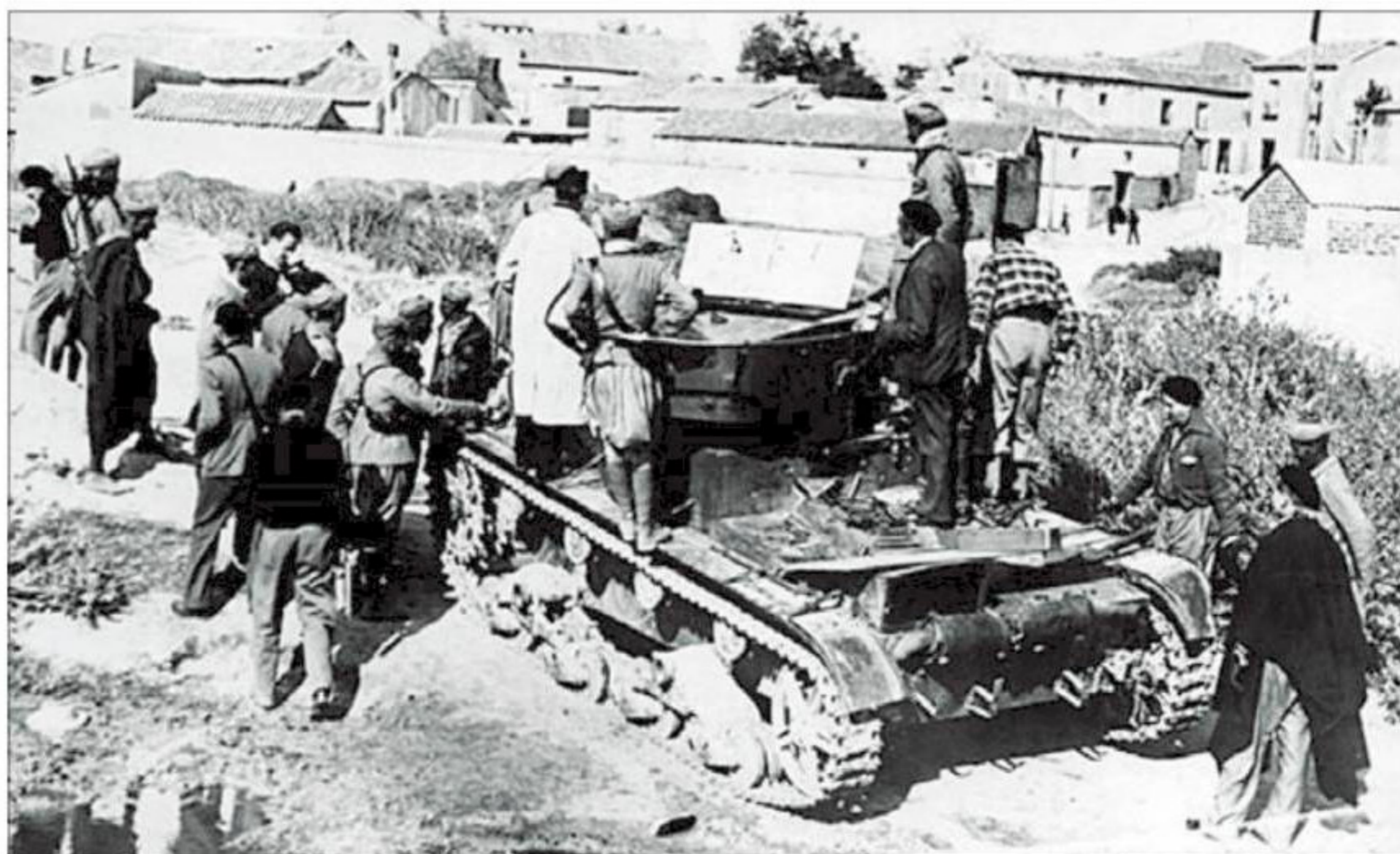
Марроканские солдаты рассматривают один из первых захваченных националистами Т-26. Это радиальный танк со срезанной левой половиной поручневой антенны. Мадридское направление, конец 1936 г.
