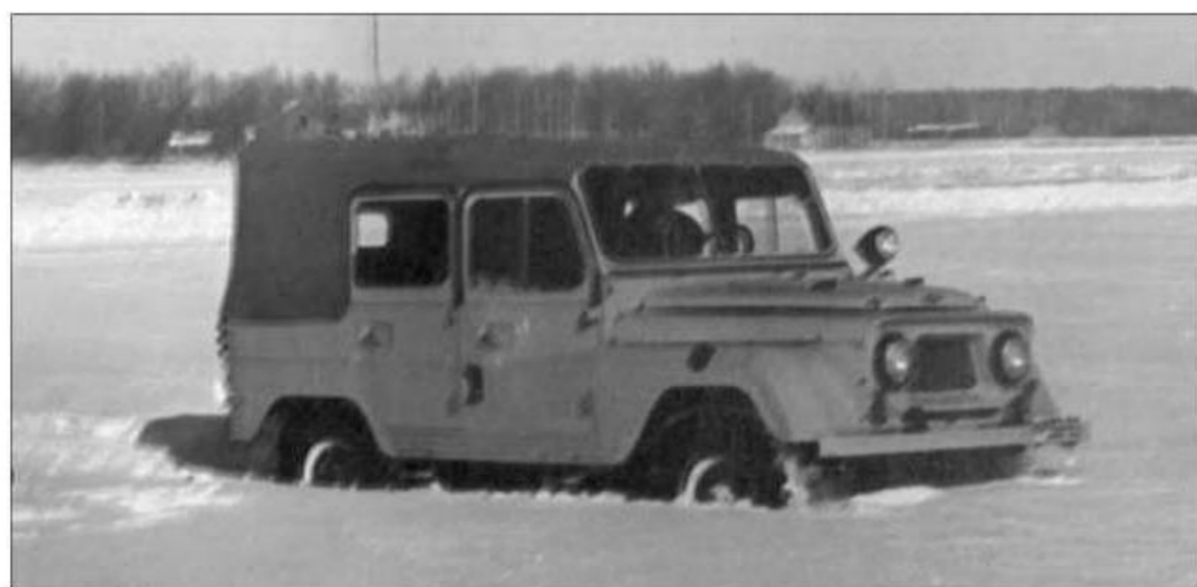
УАЗ-460Б двигается по снегу глубиной 38 см.
