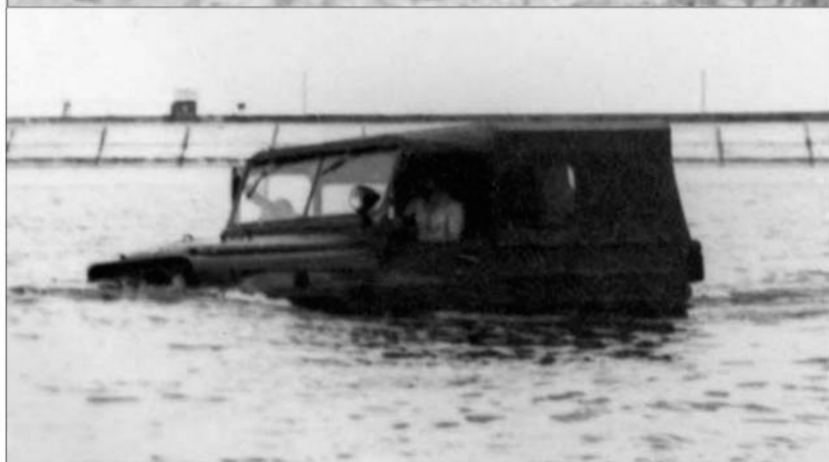
УАЗ-469 преодолевает брод глубиной 80 см, ремень вентилятора снят.
