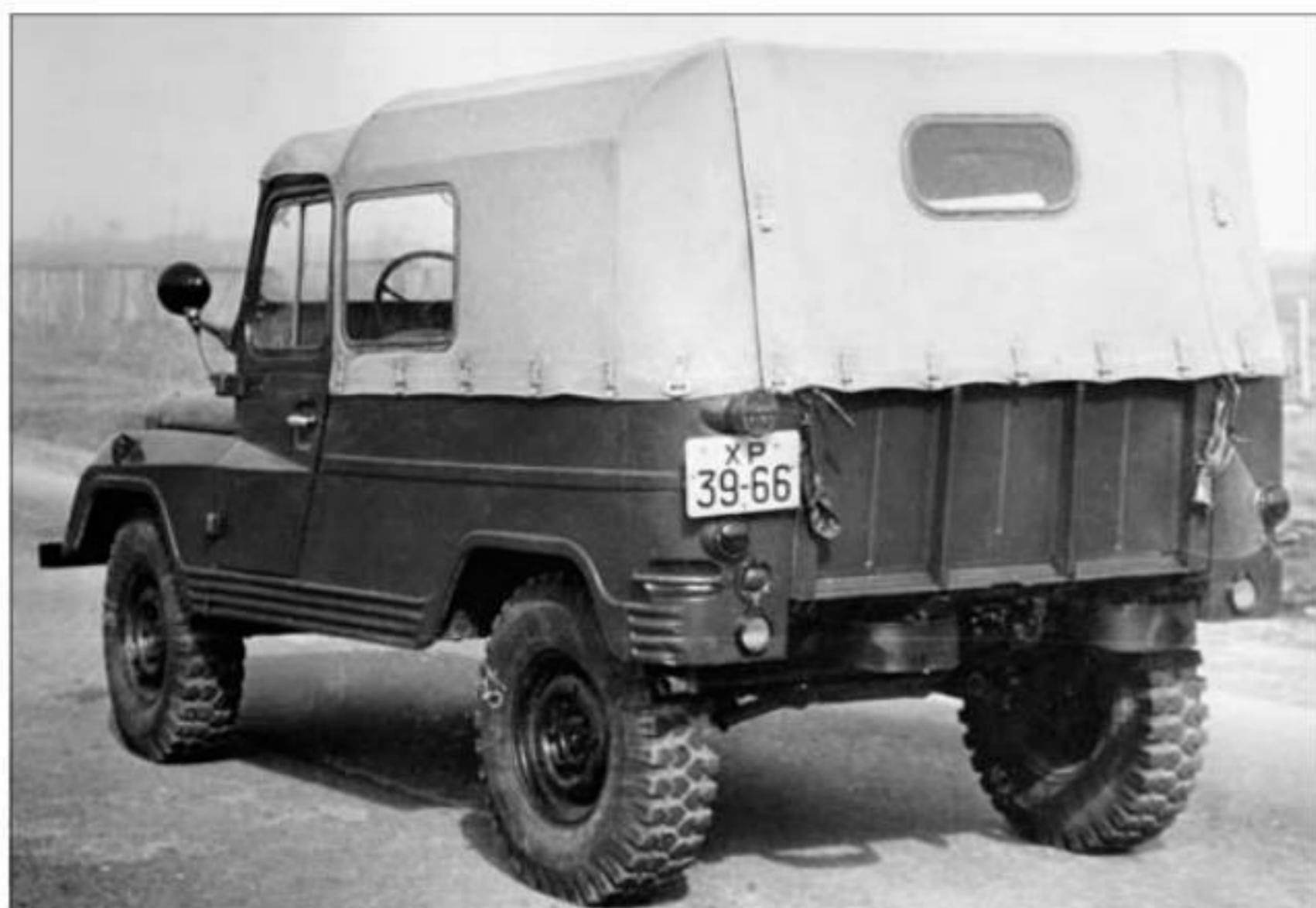
Опытный образец автомобиля УАЗ-469. Машина оснащалась трехдверным кузовом, так как с левой стороны, рядом с местом водителя, размещалось запасное колесо.
