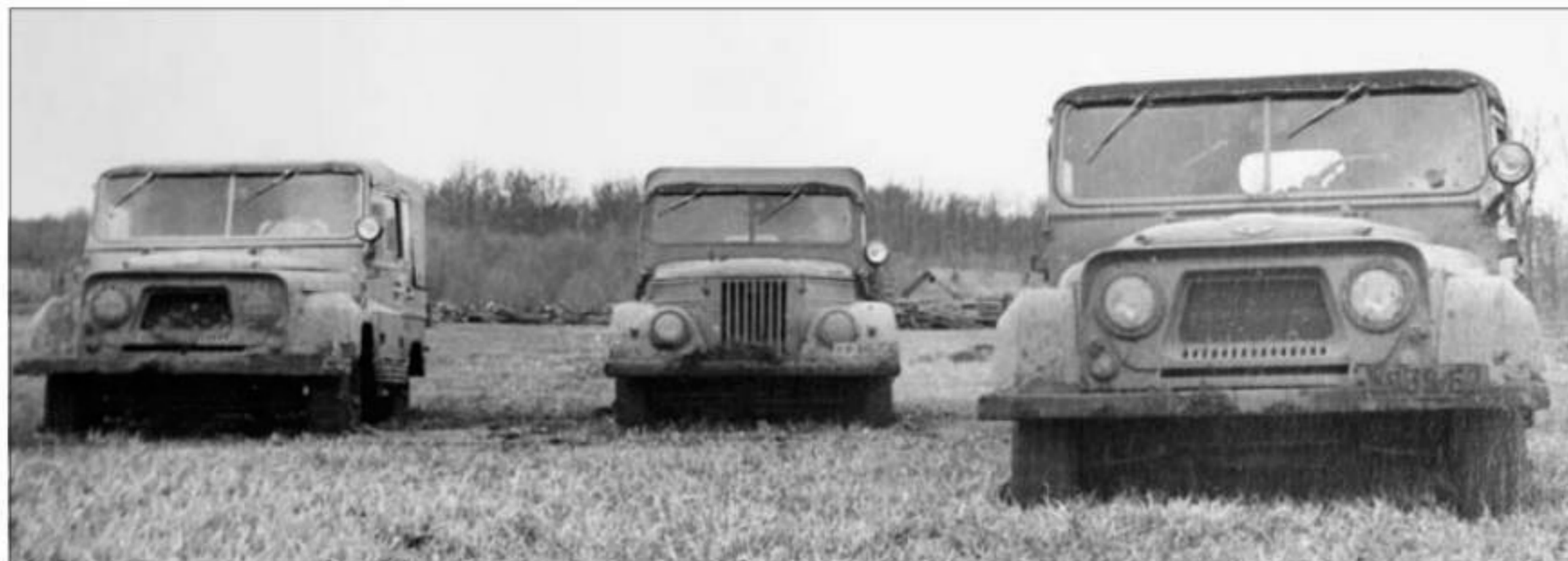
Автомобили УАЗ-460Б, ГАЗ-69 и УАЗ-469 не смогли двигаться по мокрому лугу из-за буксования колес и «засаливания» рисунка протектора.
