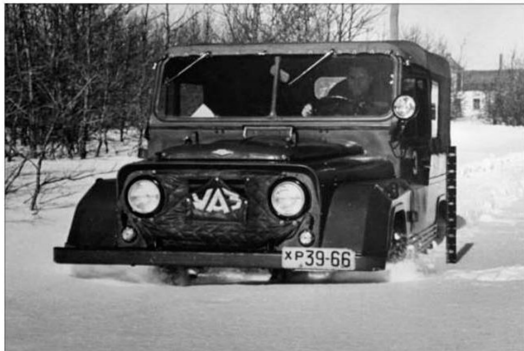
Автомобиль УАЗ-469 преодолевает снежную целину (глубина снега – 52 см), но не смог продолжить движение, когда глубина снега достигла 53 см.
