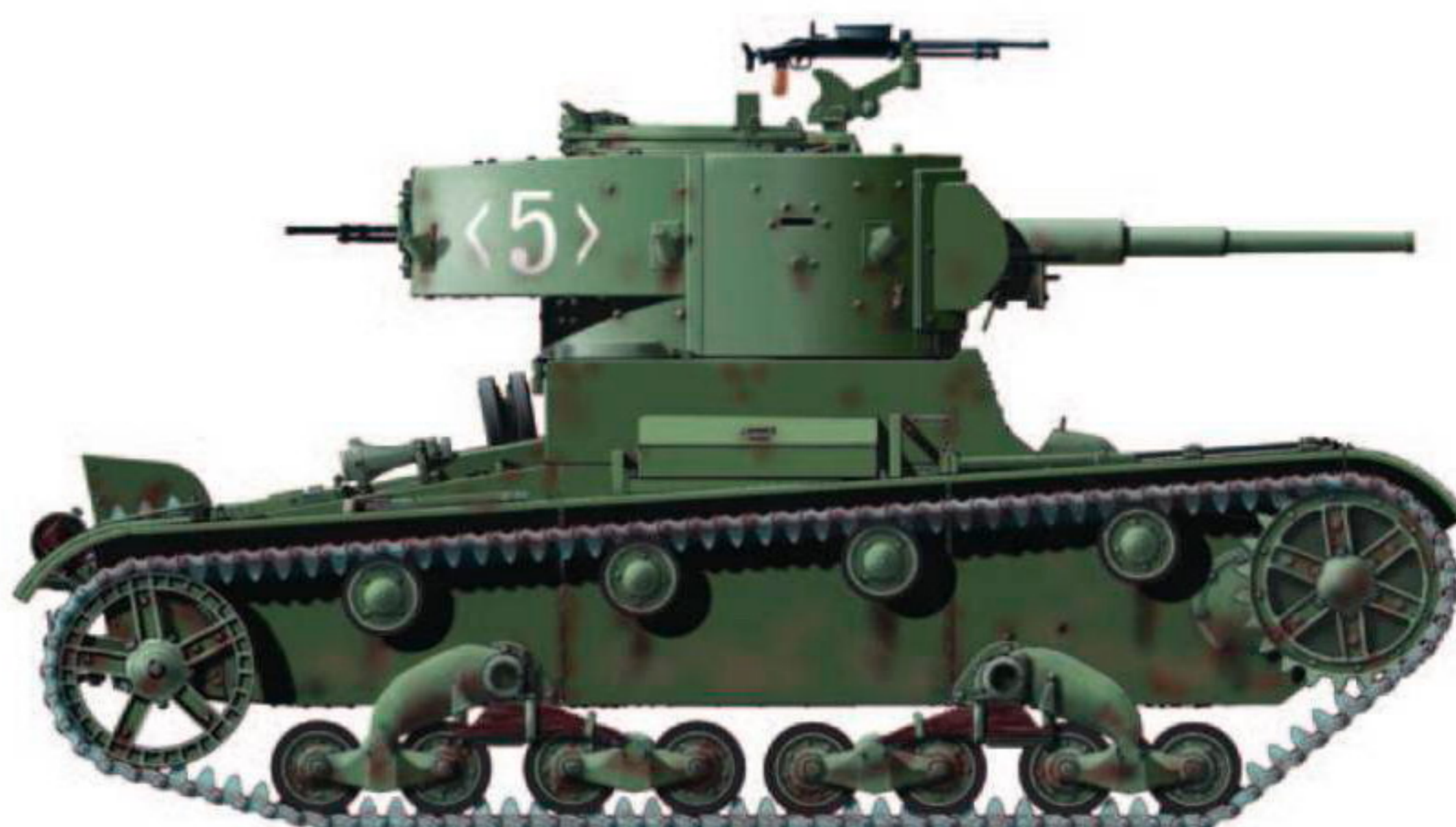
Радийный республиканский Т-26 поздних выпусков со сварным корпусом, пулеметом в кормовой нише башни и зенитной установкой П-40 с пулеметом ДТ. Эта машина была захвачена националистами на Арагонском фронте в конце 1937 г.
