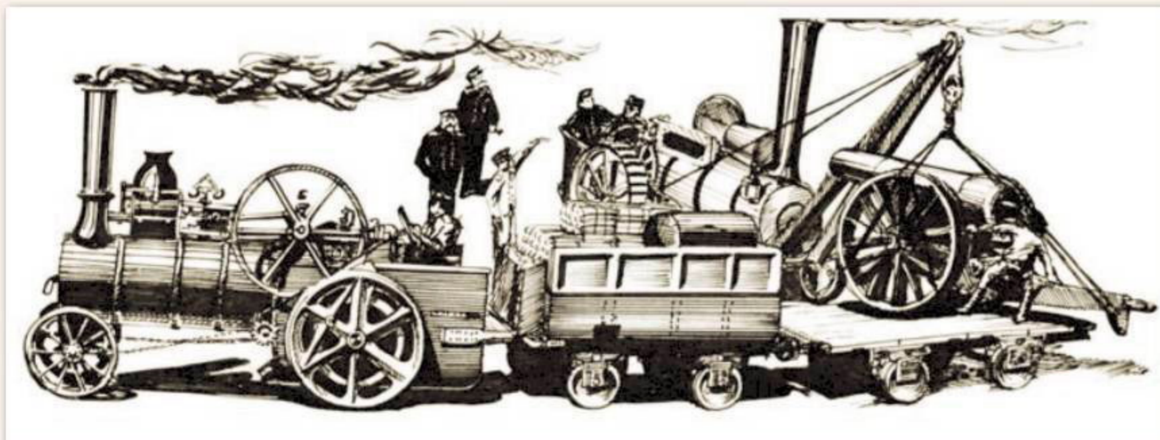
Так современный художник представляет использование рутьеров в Русско-турецкой войне. Ошибочно показан кран грузоподъемностью в 100 пудов, не поставившийся в Россию вместо 300-пудового, и погрузка орудия в боевом положении. На платформу отдельно грузились ствол орудия, лафет и колеса (рис. из книги К.В. Шляхтинского «Россия: гении и дороги»).
