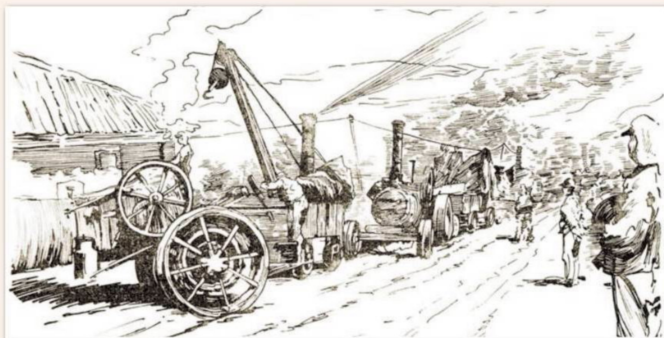
«Тягачи Мальцовского завода в г. Зимница». Художник ошибочно снабдил тягач Мальцовского завода подъемным краном, чего в действительности не было (рис. из книги Л.Д. Гоголева «Автомобили-солдаты»).
