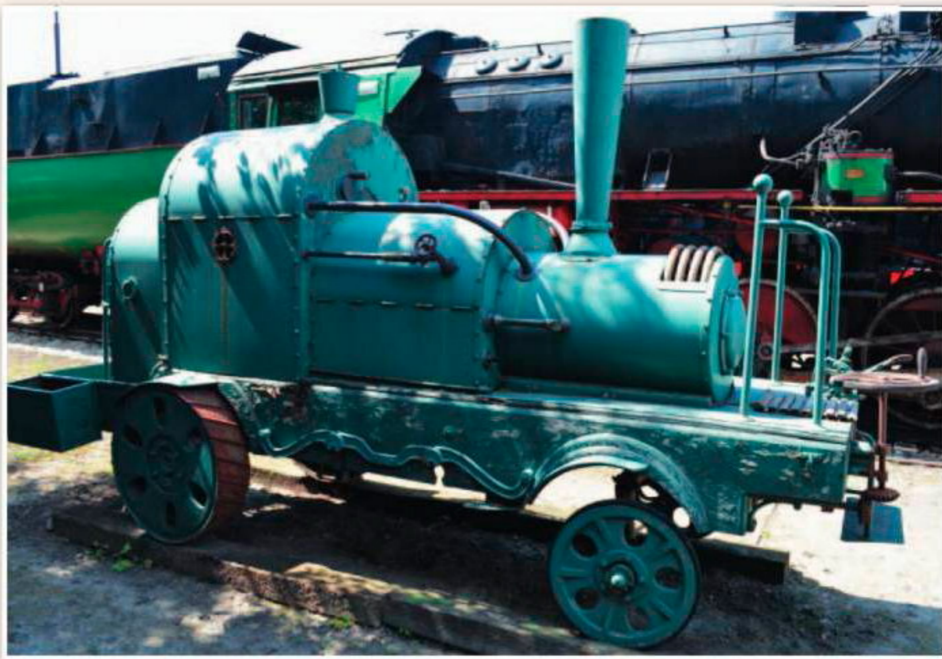
Вольная фантазия на тему «Рутьер Русской армии в Русско-турецкой войне 1877–1878 гг.». Машина создана в 2003 г. для съемок сериала «Турецкий гамбит» – электрокар с генератором дыма в передней части. В настоящее время – экспонат Национального музея транспорта и связи Болгарии в г. Русе.
