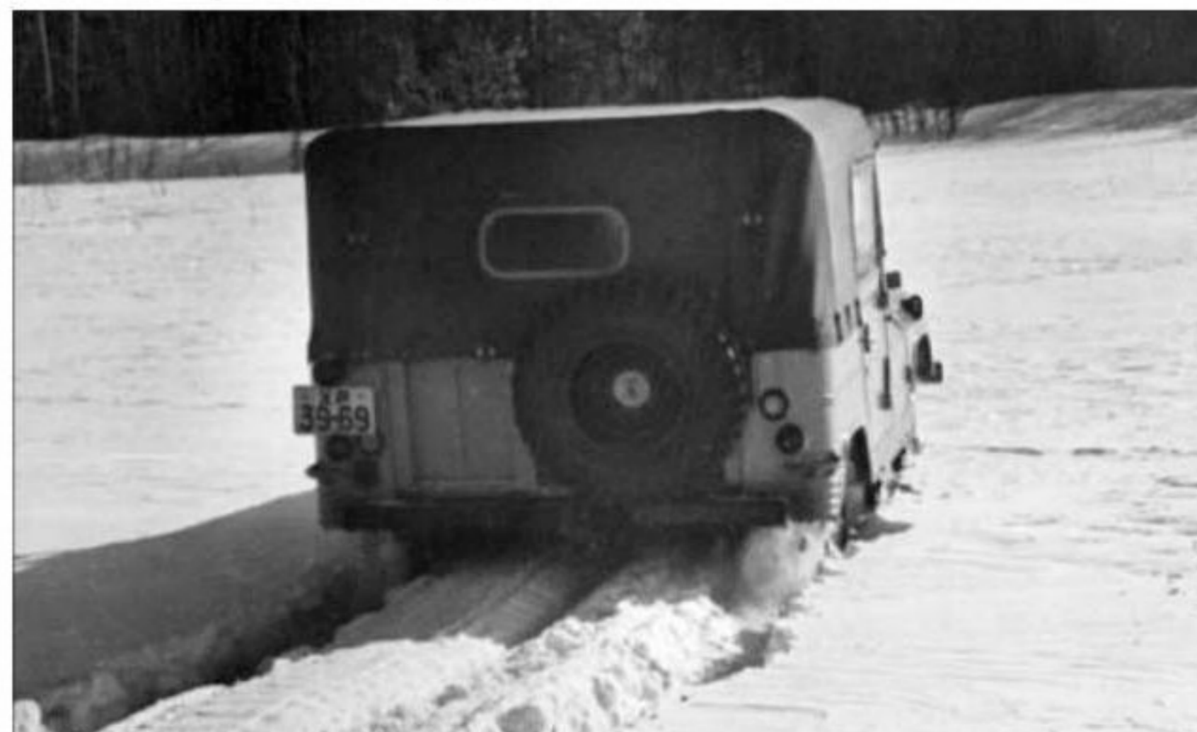
УАЗ-460Б пробивает дорогу в снежной целине толщиной до 45 см. Отчетливо виден след задевания картерами мостов за снежную целину.
