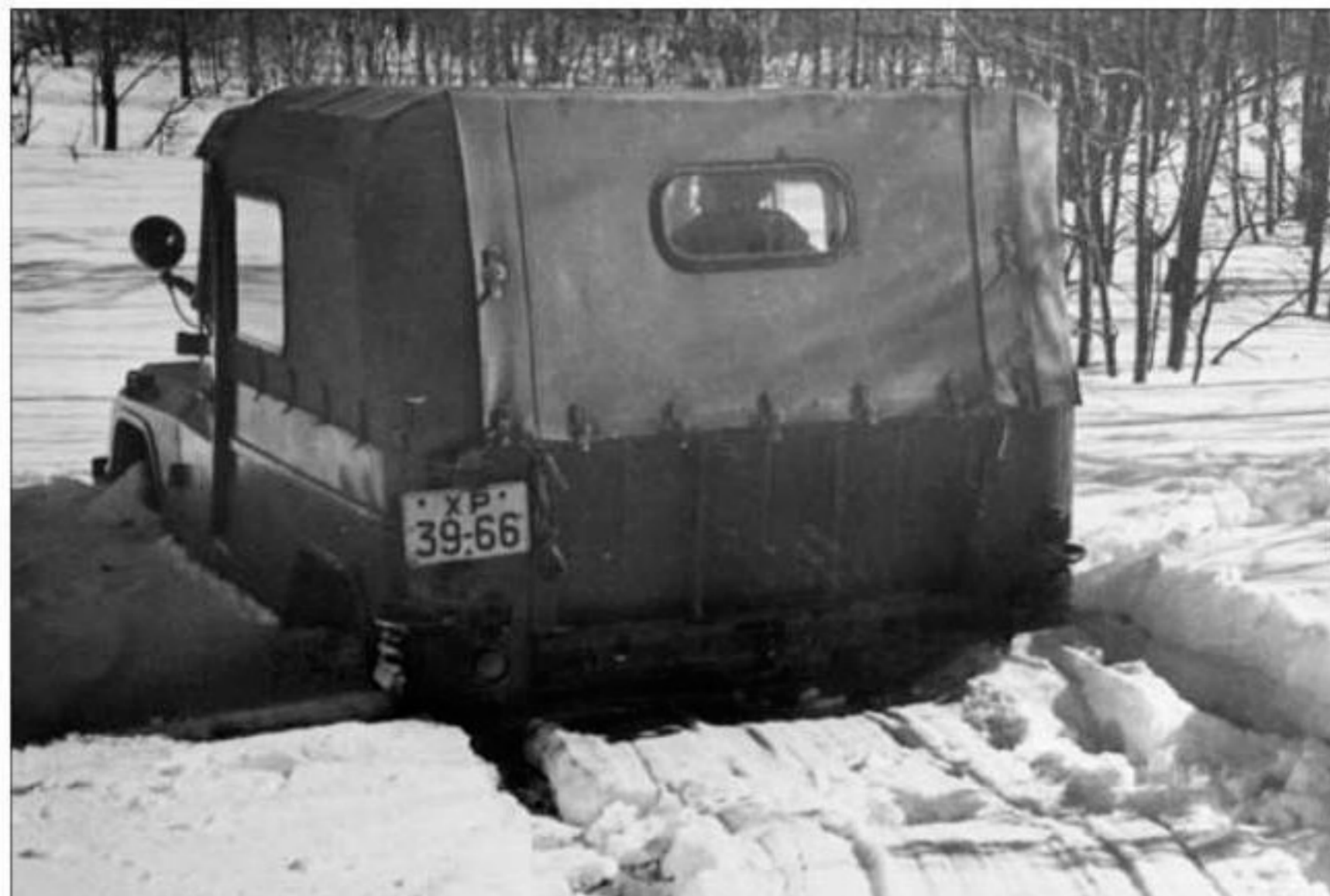
Автомобиль УАЗ-469 преодолевает снежную целину (глубина снега – 52 см), но не смог продолжить движение, когда глубина снега достигла 53 см.
