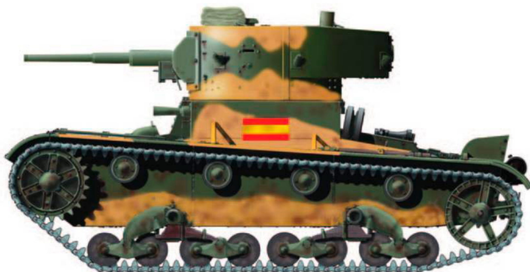
Радийный Т-26 (со срезанной антенной), захваченный националистами. Танк уже перекрашен в камуфляж, на борту подбашенной коробки нарисован красно-желто-красный франкистский флаг. 1937 г.
