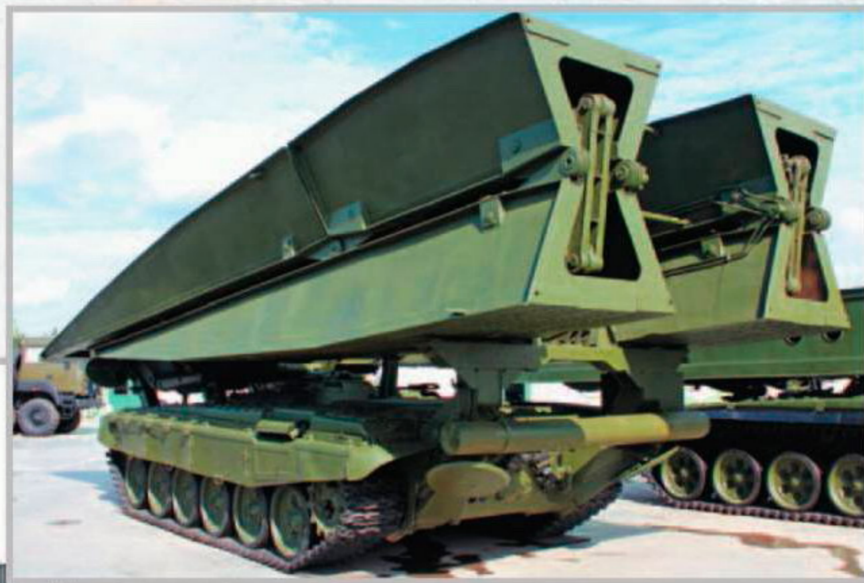
▲ Танковый мостоукладчик МТУ-90.
