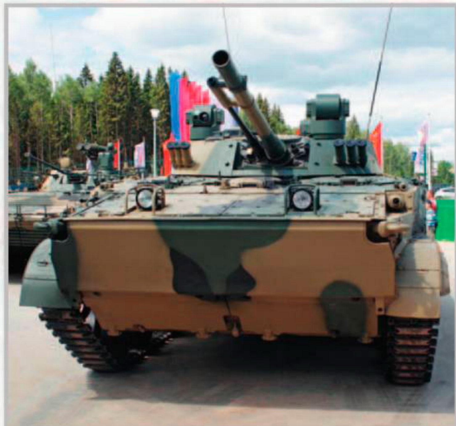
▲ Боевая машина пехоты БМП-3 с модернизированной системой управления огнем «Витязь».
