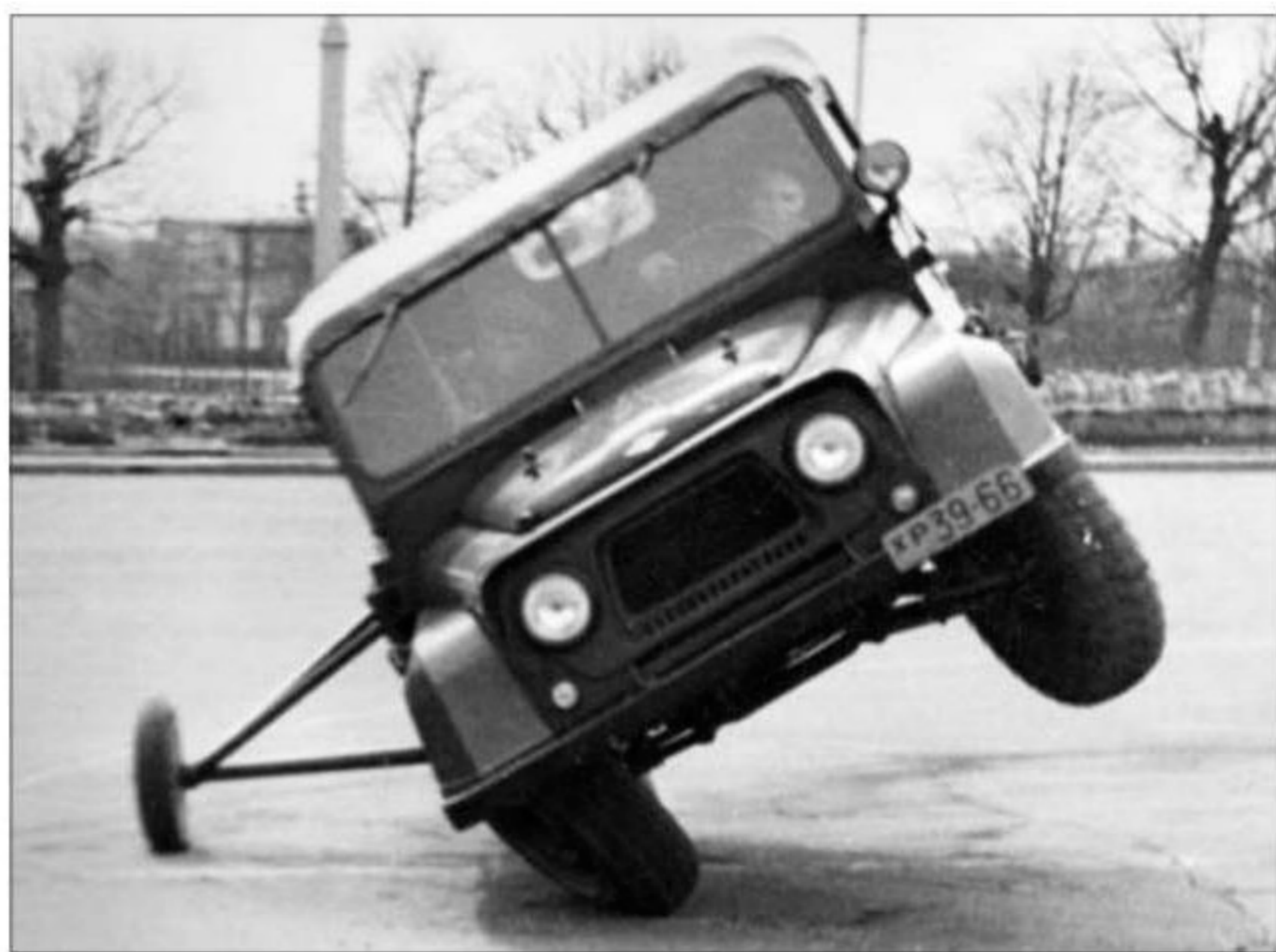
Опрокидывание автомобиля УАЗ-469, оснащенного страховочным опорным катком, при повороте на радиусе 15 м со скоростью движения перед входом на поворот 39 км/ч.
