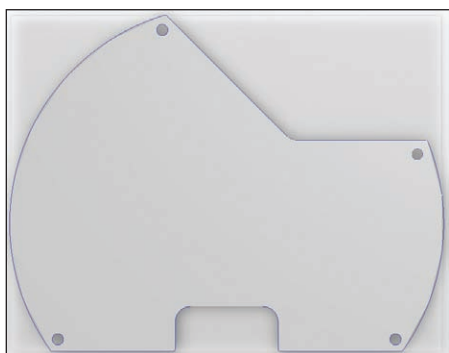
Рис. 11. Выбор грани для формирования контура печатной платы
