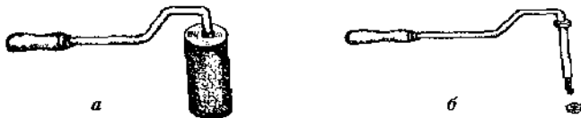
Рис. 46. Валик: а — общий вид; б — ось с рукояткой и гайкой
