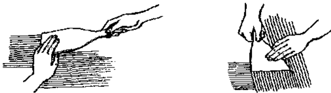
Рис. 51. Разравнивание шпатлевки шпателем
