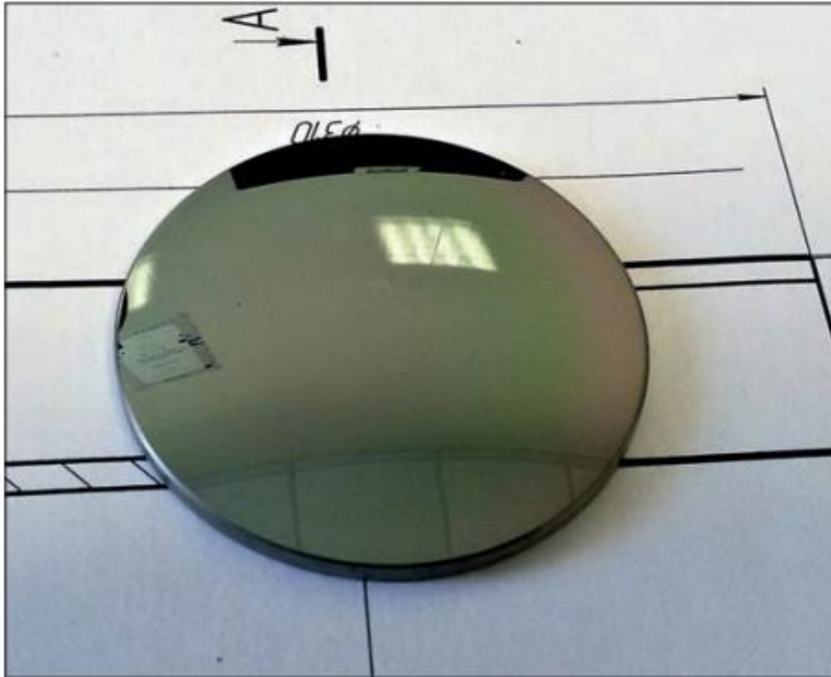
Рис. 2. Линза из оптического германия
