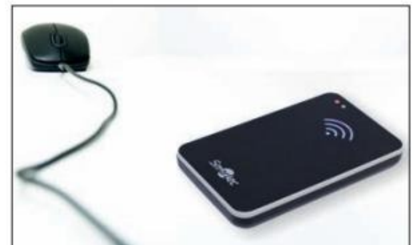
USB-считыватель ST-CE310LR для ввода кодов идентификаторов в базу данных
