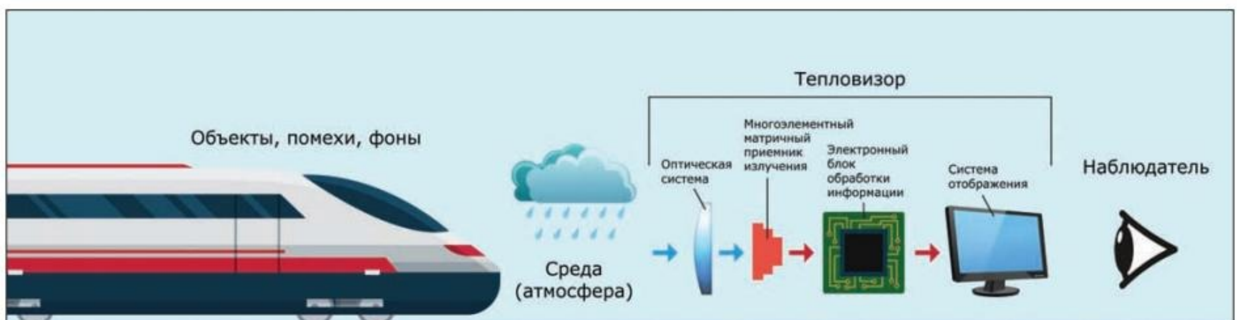
Рис. 1. Схема работы тепловизора
