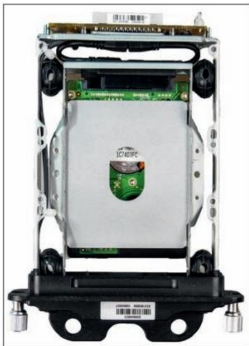
Виброзащита жесткого диска в регистраторе Hikvision
