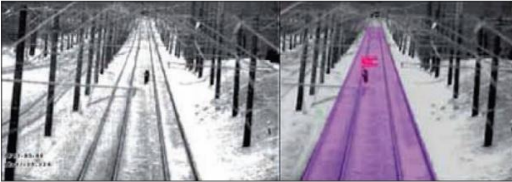
Рис. 4. Пример изображения с тепловизионного модуля. Условия: ночь, отсутствие освещения и легкий снег. Изображение "позитивное". Дальность до человека – 400 м. Дальность зоны наблюдения (выделено красным) – 1100 м
