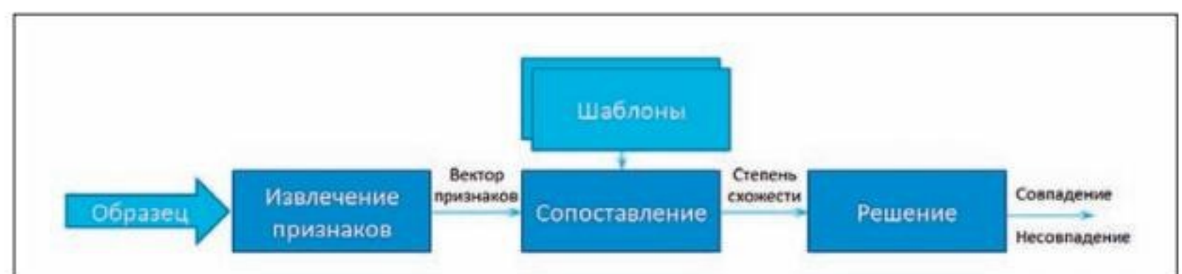
Рис. 3. Обобщенная схема обработки информации в биометрической системе
