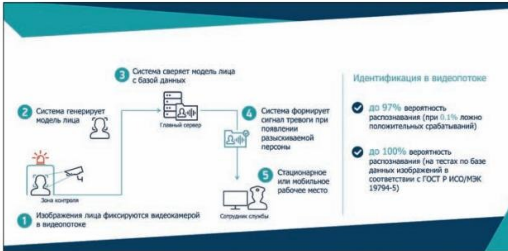
Рис. 2. Видеоидентификация по лицу. Принцип работы
