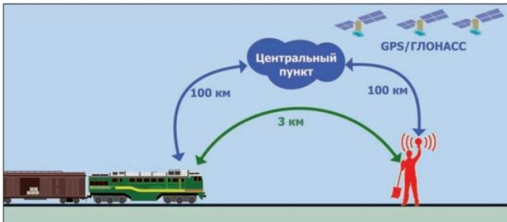
Рис. 1. Персональное оповещение. Передача сигнала "Тревога"
